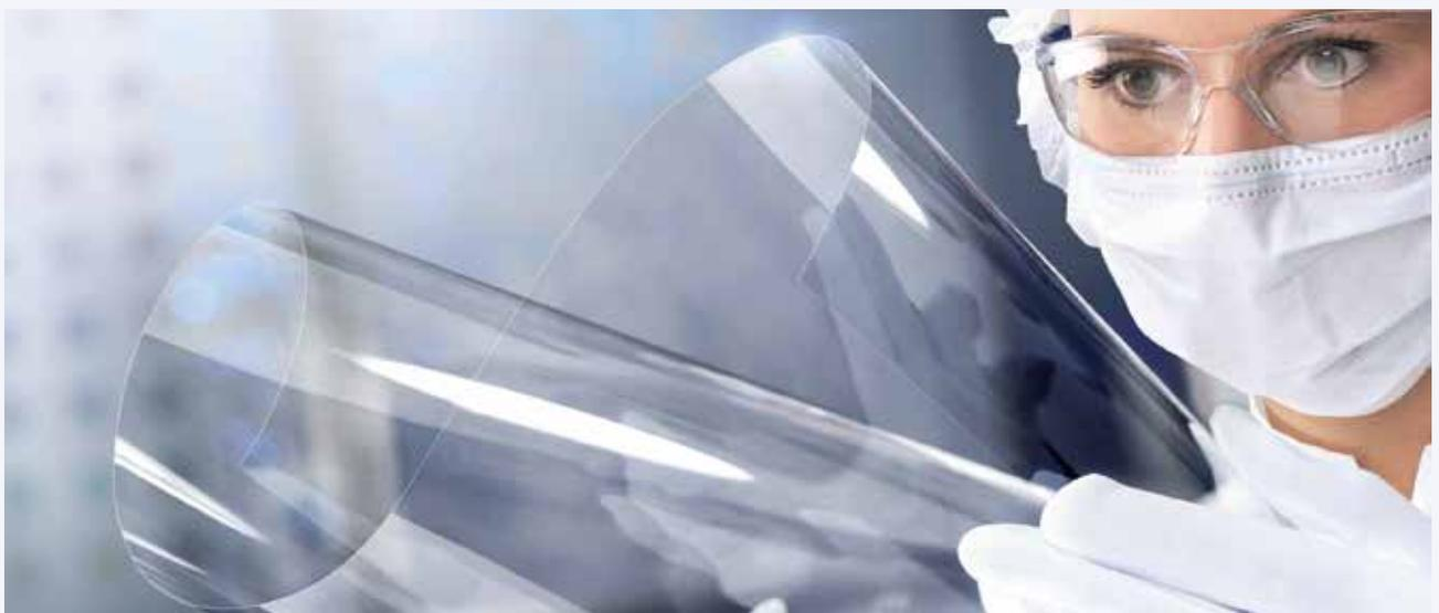
Ultradünn und biegsam – auch das kann Glas. Mit einer Dicke von nur 25 bis 150 Mikrometern eignet es sich auch für Rolle-zu-Rolle-Anwendungen.
