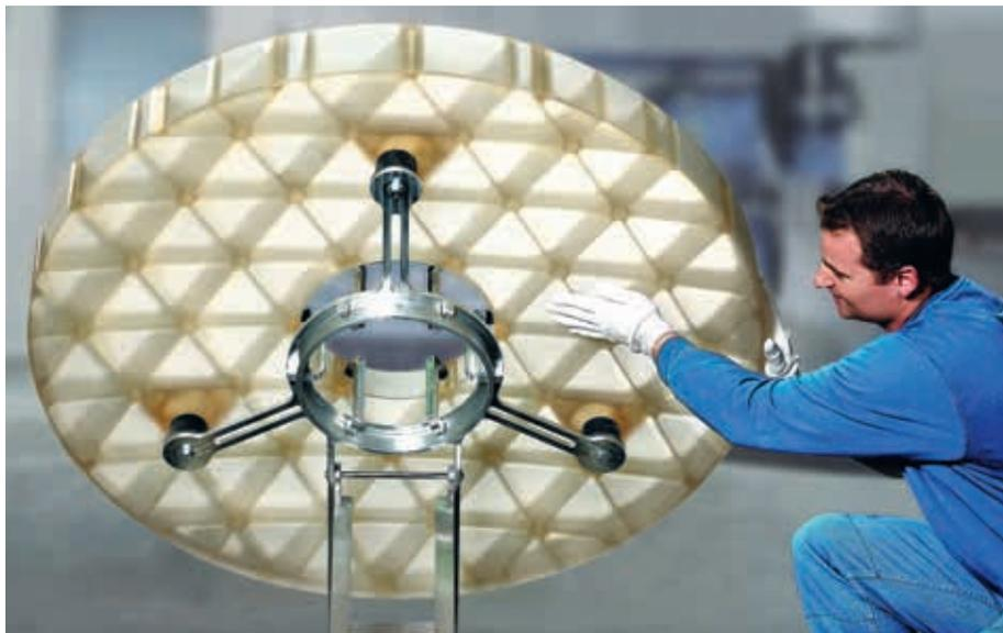
Leicht ins Weltall: Dank besonderer Herstellungstechnologien kann das Gewicht eines Spiegelträgers mit einem Durchmesser von 1,2 Meter auf nur 45 Kilogramm reduziert werden. Die dreieckigen Ausfräsungen auf der Rückseite ermöglichen eine Gewichtsreduktion um bis zu 90 Prozent.
