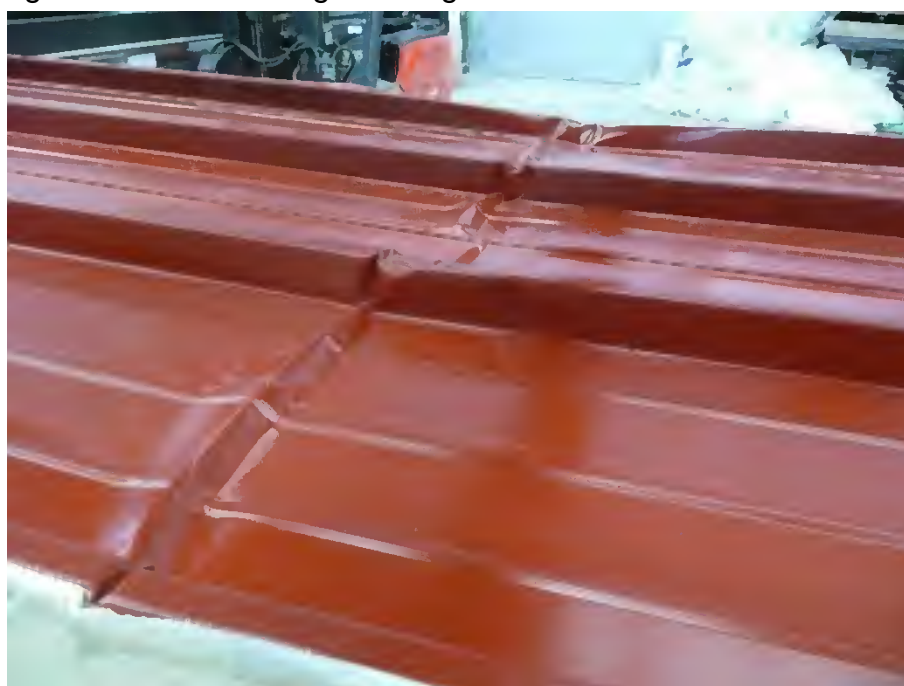
Abbildung 2-4: Knitter von Sandwichelementen, hier gedrücktes oberes Deckblech eines Dachelements
