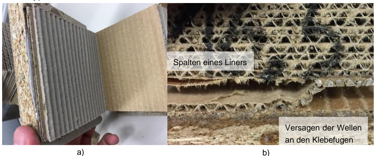
Abbildung 4-31: Zugversuch Versagensbilder: Klebefuge zwischen Welle und Liner (a) sowie Spalten eines Liners und Versagen der Wellen an der Klebefuge (b)
