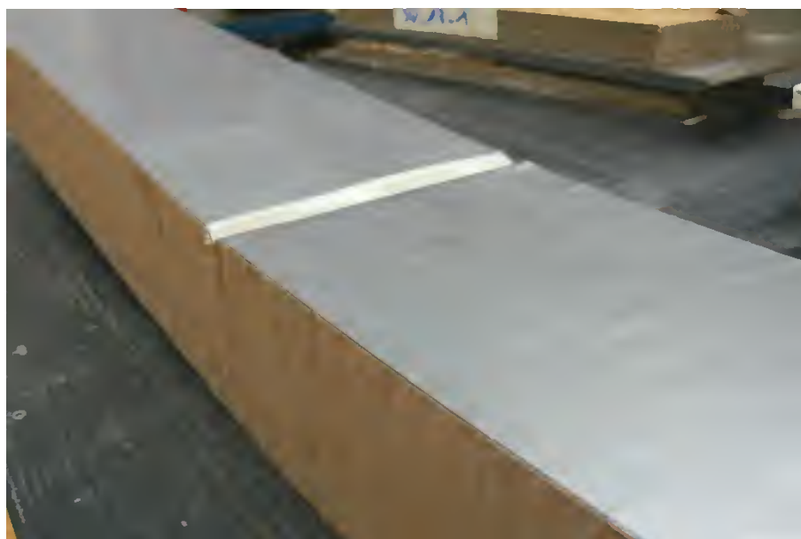
Abbildung 6-16: VR1-T2-2 – Knitterfalte und zahlreiche plastische Beulen in oberer Deckschicht Figure 6-16: VR1-T2-2 – Wrinkling and numerous plastic buckles in upper face sheet
