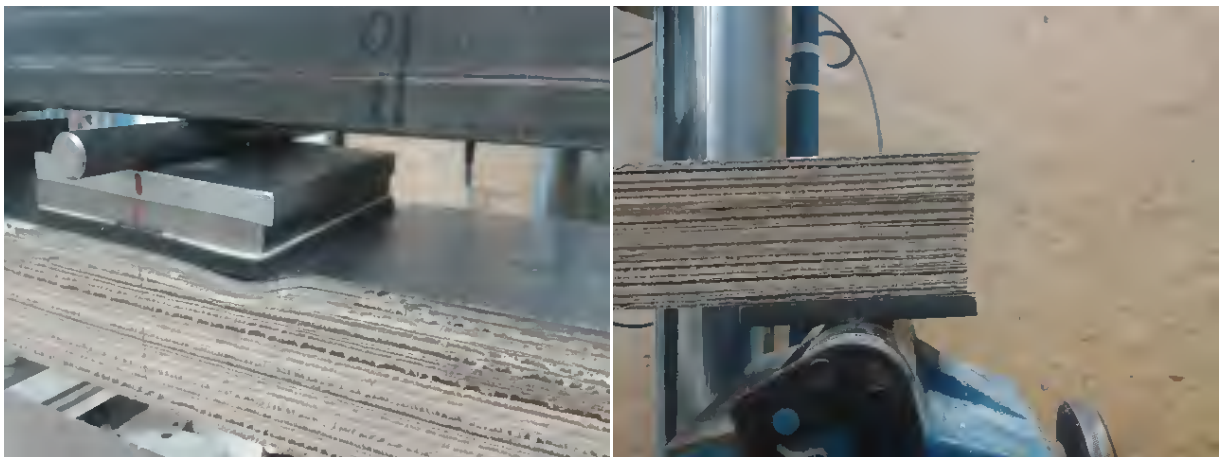
a) Druckversagen des Kerns an der Lasteinleitung (Probe VR1-T1-1)
