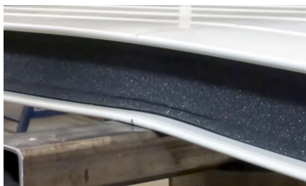
Abbildung 2-3: Typisches Druckversagen an einem Auflagerpunkt, NELKE (2018)
