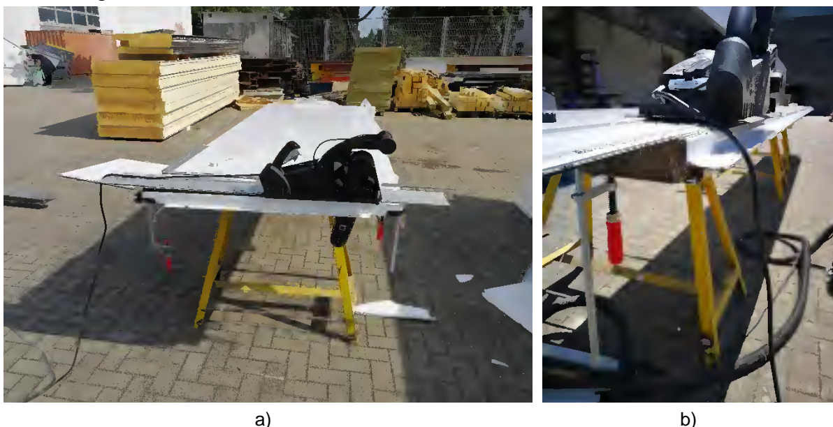
Abbildung 6-4: Zuschnitt der Proben von Versuchsreihe VR 4 mit Hilfe einer Paneelsäge, a) Stirnseite, b) Längsseite (Umkantung der Deckbleche erkennbar)
