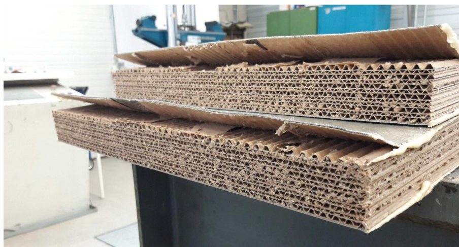
Abbildung 6-13: VR3-T1-1 - An Knitterfalte aufgeschnittener Probekörper, Zugversagen der Wellpappe
