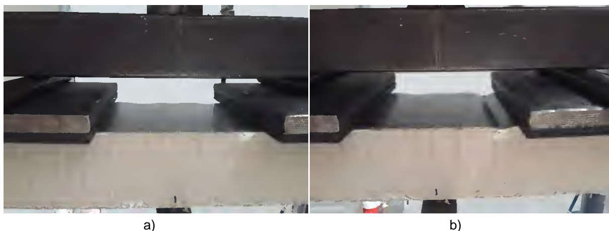
Abbildung 6-18: VR2-T2-1: Beulen im oberen Deckblech (a) und Knitterfalte (b)
