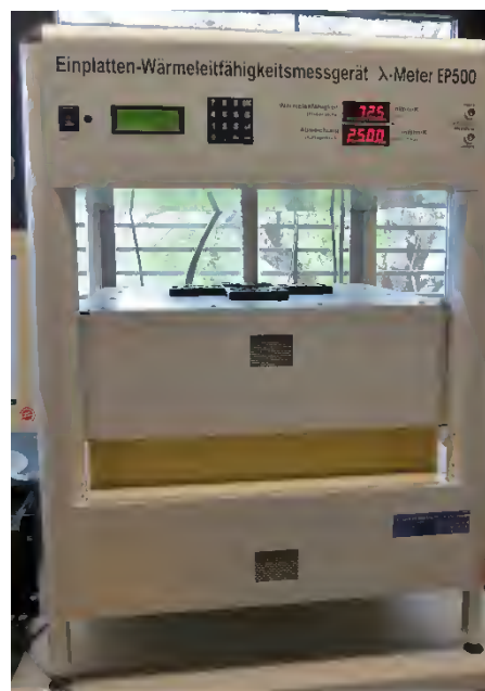
Abbildung 5-1: Einplattenmessgerät „λ-Meter EP500e“ zur Bestimmung der Wärmeleitfähigkeit
