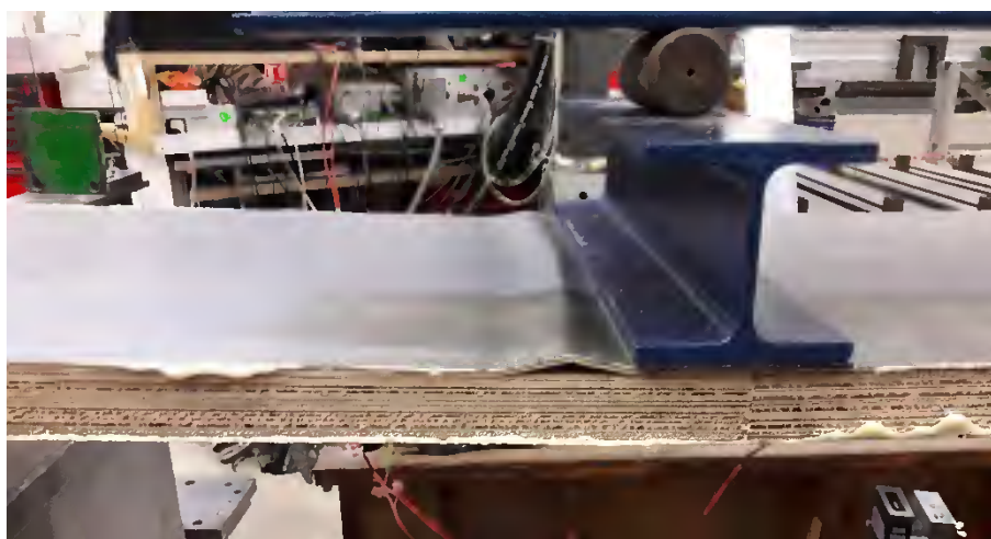
Abbildung 6-14: VR3-T1-2: Knittern zwischen Lasteinleitung und Auflager
