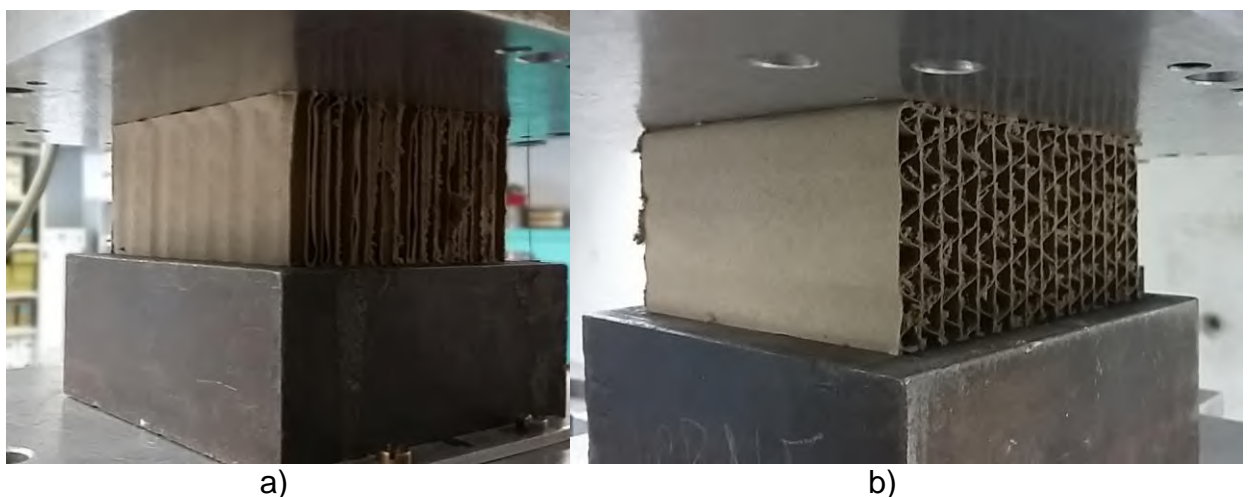
Abbildung 4-26: Versagensbilder der Druckversuche für Achse 2 (a) und Achse 3 (b) Figure 4-26: Pictures at failure of the compression tests for axis 2 (a) and axis 3 (b)
