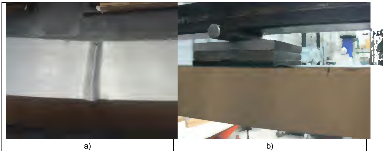
Abbildung 6-36: Versagensbilder Typ 3 Serie VR1-T3-1 bis VR1-T3-3, a) Fließversagen mit anschließendem Knittern, b) Delamination von VR1-T3-3
