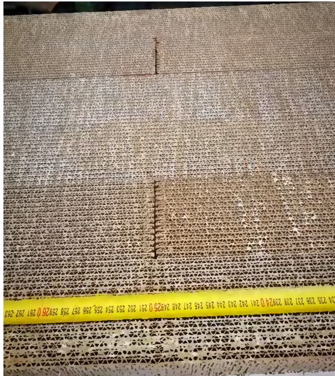
Abbildung 6-31: VR4-T2-2: Lamellenstöße unterhalb der Knicke im oberen Deckblech
