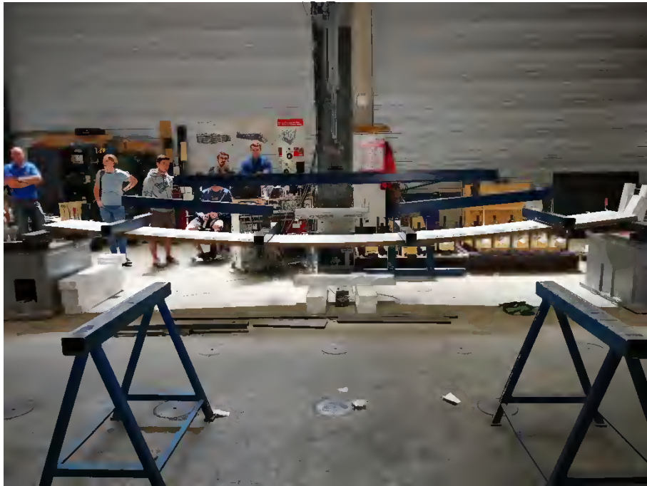
Abbildung 6-27: VR4-T2-2: Fotografie während des Versuchs vor dem Versagen
