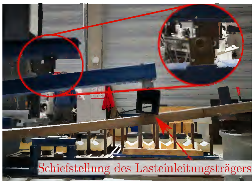
Abbildung 6-33: Schiefstellung des Lasteinleitungsträgers
