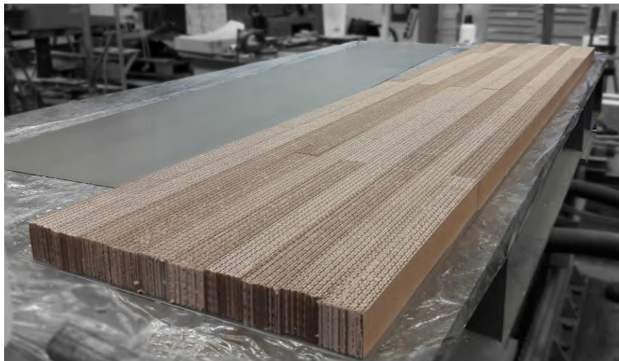
Abbildung 6-3: Probenherstellung: Vorgefertigte Wellpappenlamellen auf unterem Deckblech (Hier Elementtyp 2)
