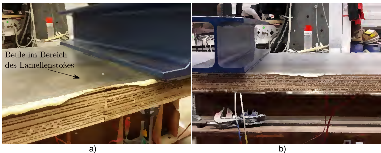
Abbildung 6-12: VR3-T1-1: Beule am Stoß der äußeren Lamelle (a) und Knitterfalte im Bereich des Momentenmaximums (b)
