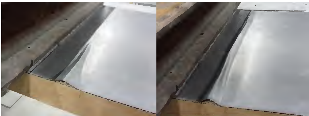
Abbildung 6-20: VR3-T2-1: Delamination mit Beule an einer der Elementkanten (a) und Knitterfalte über gesamte Elementbreite (b)
