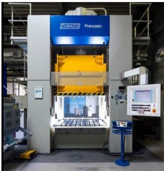
Abbildung 4-4: Hydraulische Doppelständerpresse der Fa. DUNKES
