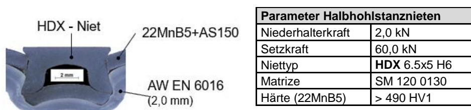
Abbildung 5-64: Materialdickenkombination 2 – Einfluss des Werkstoffes und der Beschichtung der Außenhaut auf den Schweißbereich
