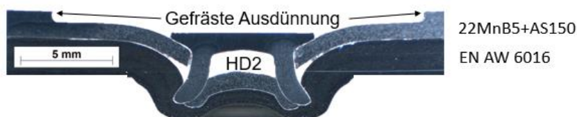
Abbildung 5-74: Materialdickenkombination 3 – Einfluss der Werkstoffdicke auf die mechanische Fügbarkeit (Analogieversuch 2)
