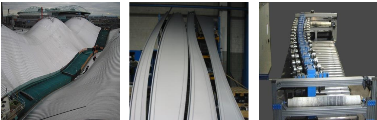
Abbildung 2-2: Dach des Zentralbahnhofs in Sydney (links); X-Tail Profil der Firma Kalzip (Mitte); Flexible Profilieranlage (rechts) (Döhren 2006)
