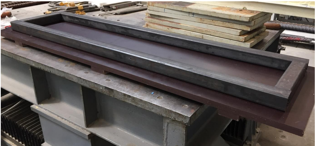
Abbildung 6-15: Schalung für die Voruntersuchungen
