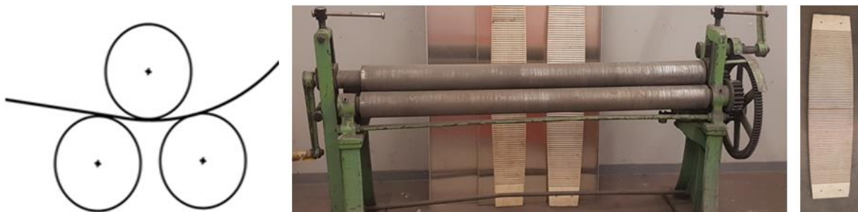
Abbildung 7-17: 3-Punkt-Biegeanlage und Holzkerne (nach [xxx])
