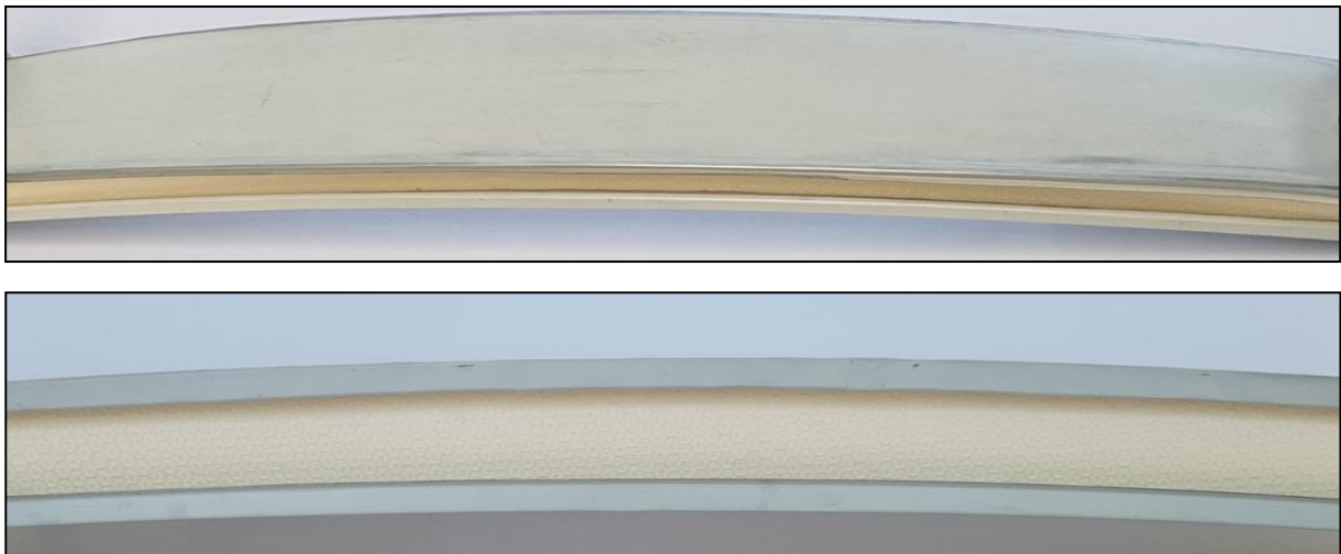
Abbildung 7-20: Flexibel profiliertes und gekrümmtes Sandwichelement
