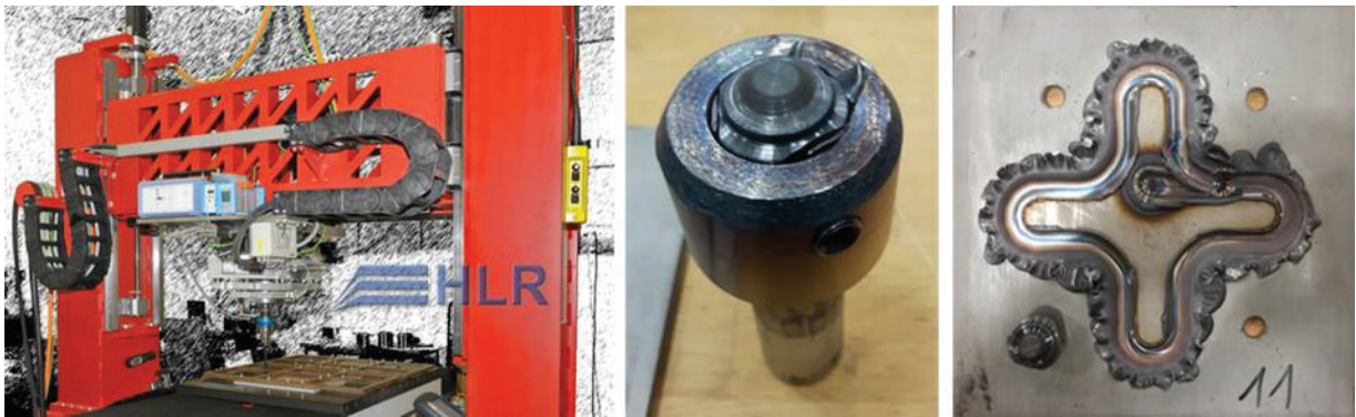
Abbildung 4-4: Versuchsaufbau der Testschweißung mit FSW-Anlage (links), Werkzeug mit Halterung (Mitte) sowie dem Testblech (rechts)
