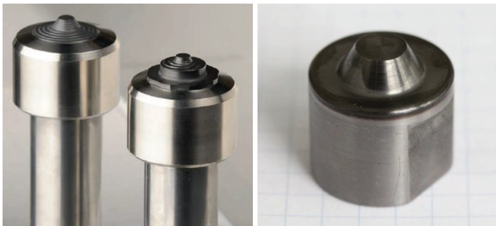
Abbildung 1-1: Typische Werkzeuge für Rührreisschweißen an Stahl, links pcBN (Quelle ESAB), rechts metallisches Werkzeug (Quelle SLV B-B)
