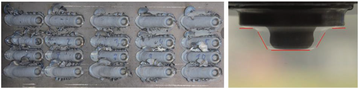
Abbildung 4-7: Werkzeugverschleiß nach ca. 9,5 Meter Schweißnahtlänge
