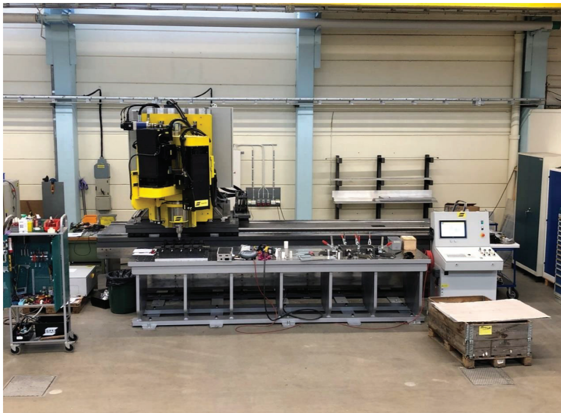
Abbildung 5-15: FSW-Versuchsanlage bei ESAB in Laxa, Schweden
