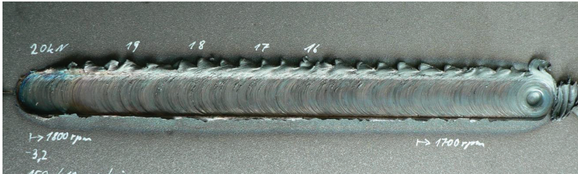
Abbildung 3-9: Rührreibschweißung mit WRe05-Werkzeug
