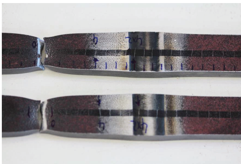
Abbildung 5-10: Zugprüfung an 8,0 mm S355JR, Versagen im Grundwerkstoff Figure 5-10: Tensile test on 8.0 mm S355JR, failure in base material
