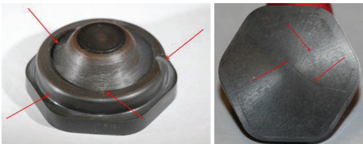
Abbildung 5-3: Keramisches Werkzeug mit Rissen (nach dem Schweißen) Figure 5-3: Ceramic tool with cracks (after welding)
