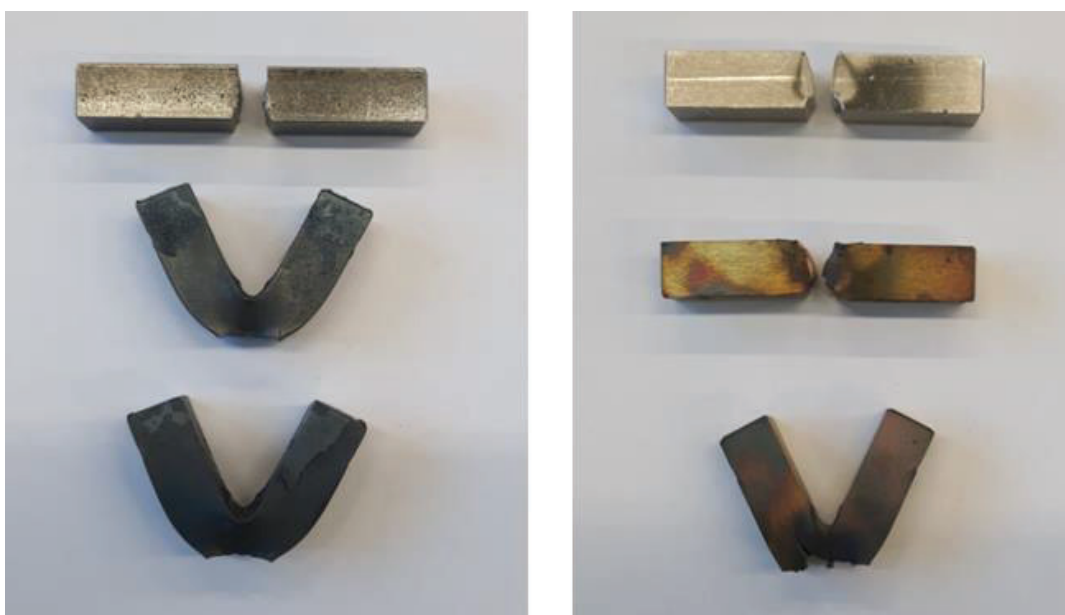
Abbildung 3-8: Kerbschlagbiegeversuch bei 1100°C (rechts: S235JR, links: X5CrNi18-10)
