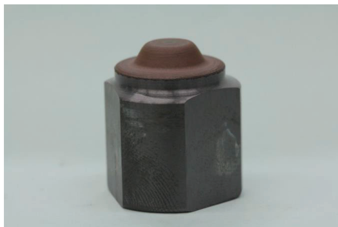
Abbildung 5-8: Keramisches Werkzeug aus Si 3 N 4 nach 5,0 Meter Schweißnaht
