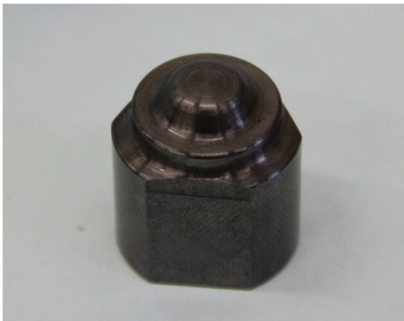
Abbildung 5-6: Keramisches Werkzeug (Werkzeugeinsatz) der zweiten Generation Figure 5-6: Ceramic tool (tool insert) of the second generation
