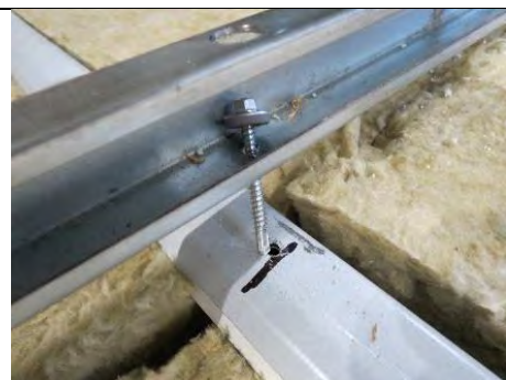
Abbildung 4-182: Herausziehen des Befestigungsmittels aus den schmalen Kassettengurten Figure 4-182: Fastener pulling out of the small liner tray flange
