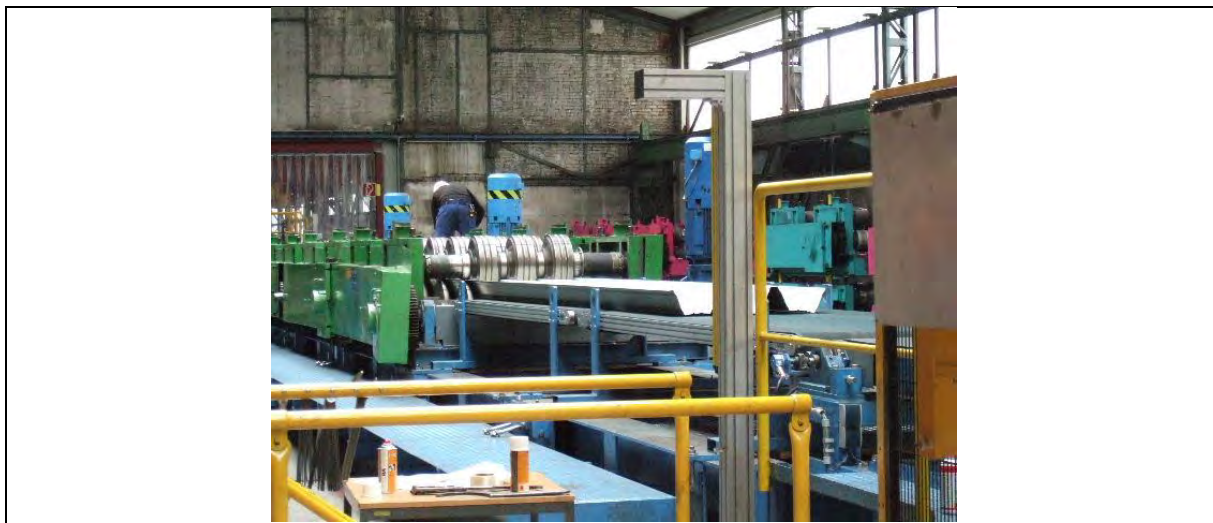
Abbildung 2-110: Rollformanlage für Feiblech Figure 2-110: Roll forming line for thin sheets
