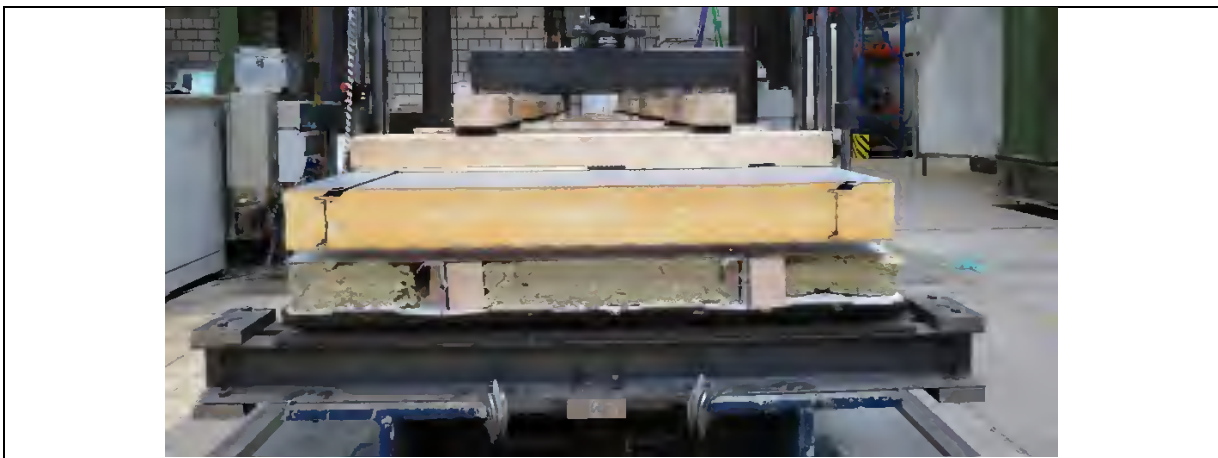
Abbildung 4-172: Seitenansicht Hybridquerschnitt mit horizontal verlegten Sandwichelementen
