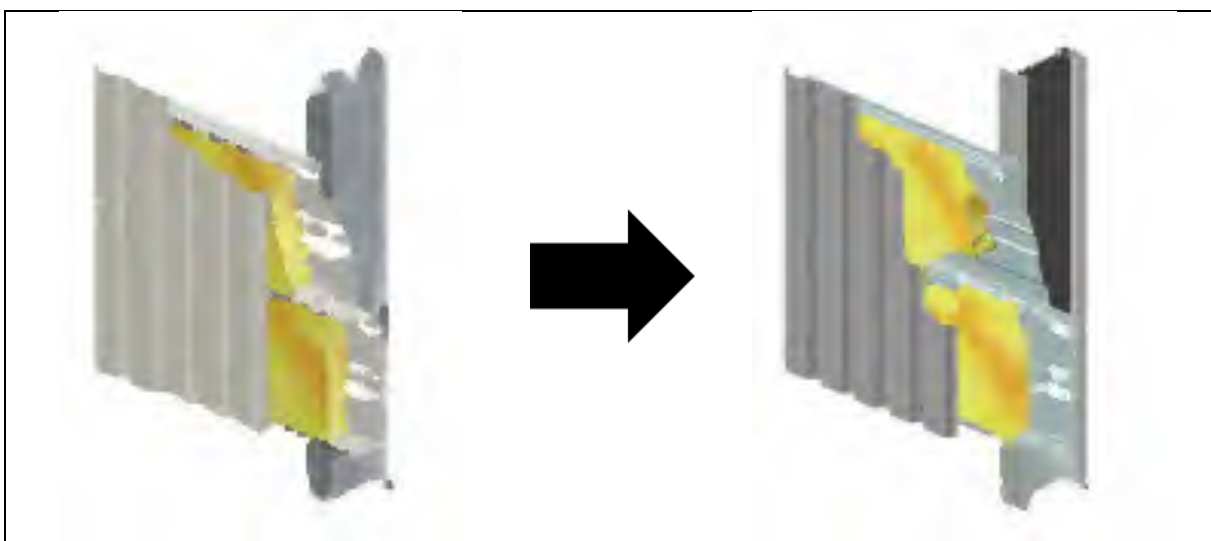
Abbildung 4-69: Sanierung einer Kassettenprofilfassade mit Distanzbefestigern [41]
