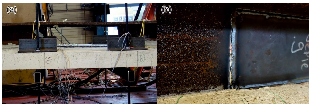
Abbildung 4-53: Kombiniertes Versagen des Trägers VT2b: (a) Biegeversagen Teilträger, (b) Schubversagen der Schweißnaht „Öffnung 1“
