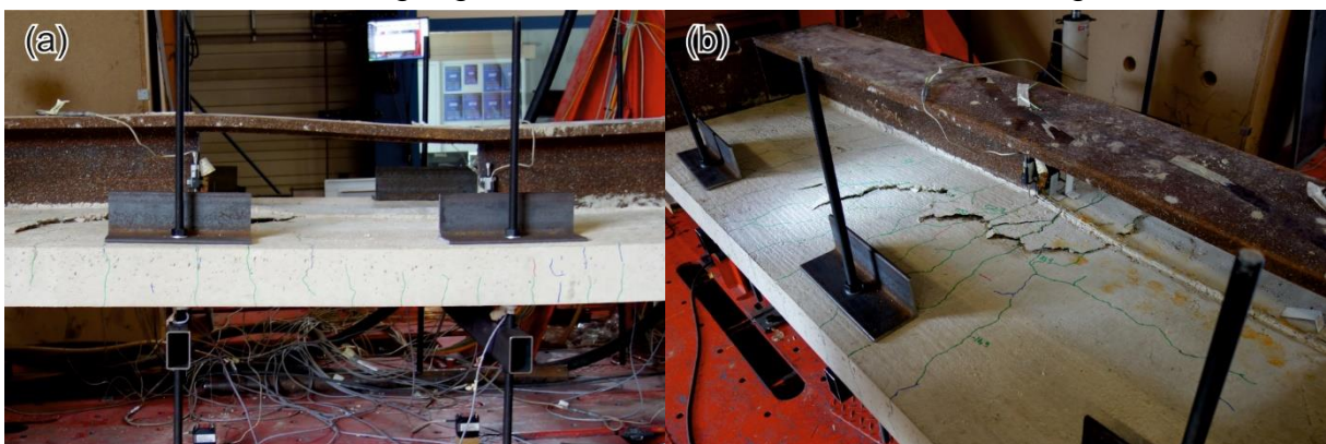
Abbildung 4-52: Kombiniertes Versagen des Trägers VT2a: (a) Biegeversagen Teilträger, (b) Verbundmittelversagen
