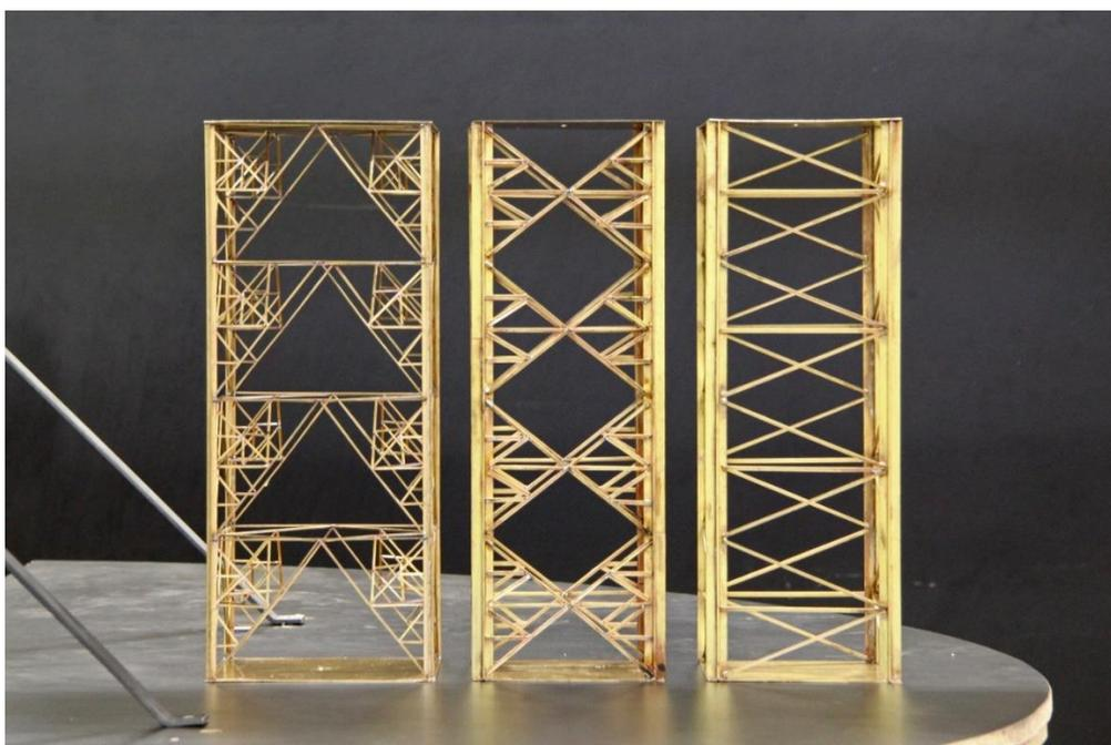
Abbildung 5-4: Scharfkantige Sektionsmodelle
