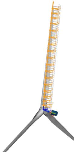
Abbildung 4-1 Rotorstrukturmodell des Referenzrotors mit Darstellung der zur aerodynamischen Lastaufprägung verwendeten Marker
