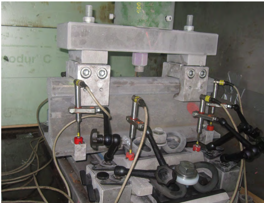
Abbildung 4-2: Systems BSP FF-B2 im Prüfaufbau zur Ermittlung der vertikalen Federsteifigkeit
