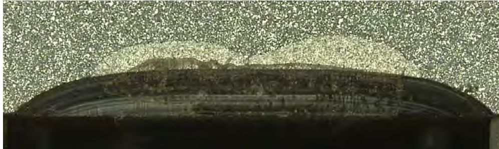
Abbildung 6-23: Von zwei Startpunkten ausgehendes Risswachstum
