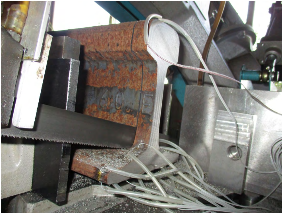
Abbildung 5-7: Sägeschnittverfahren (zweiter Schnitt)
