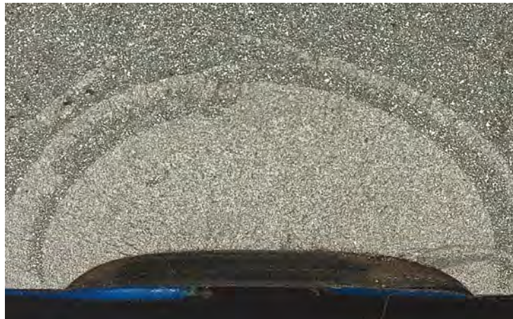
Abbildung 6-20: Ermüdungsbruchfläche mit mehreren Spaltbrüchen gegen Versuchsende Figure 6-20: Area of fatigue fracture with several cleavage fractures towards closing the test
