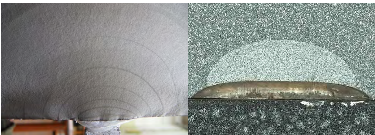
Abbildung 6-22: Vergleich von Bruchfläche mit angestrebten Rastlinien (links) [Lan16b] und Schienenbruchfläche ohne Rastlinien trotz Prüfung mit Spannungsvariation (rechts)
