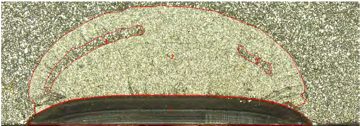
Abbildung 6-31: Ermüdungsbruchfläche mit zwei lokalen Spaltbrüchen (Flächenanteil: 6,5%)
