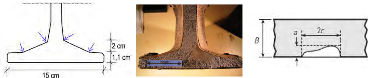
Abbildung 5-9: links: Geometrische Kerben im Schienenfuß; mitte: Ein Riss, der in einer geometrischen Kerbe startete [Kot12]; rechts: Rissbenennung [BSI 7910]
