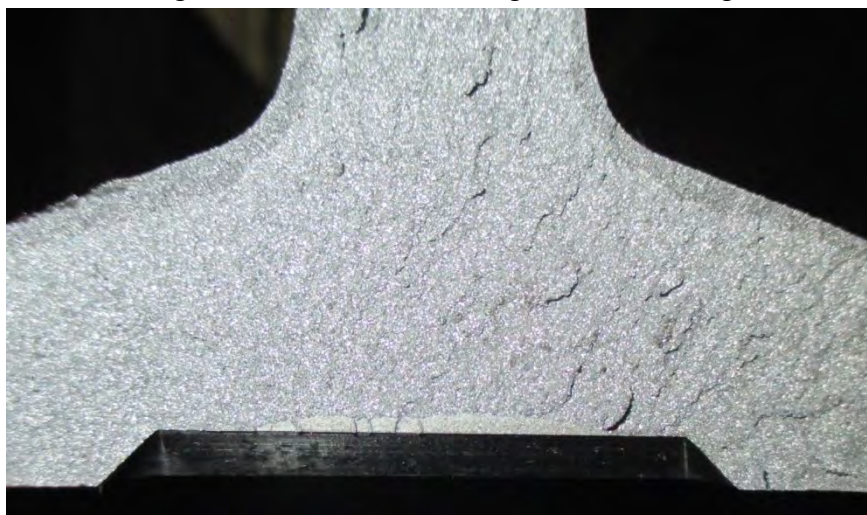
Abbildung 6-12: Bruchfläche mit schwach ausgeprägtem Tiefenwachstum des Risses bei Kerbe mit Tiefe a = 4,0 \text{ mm} (Vorversuch)
