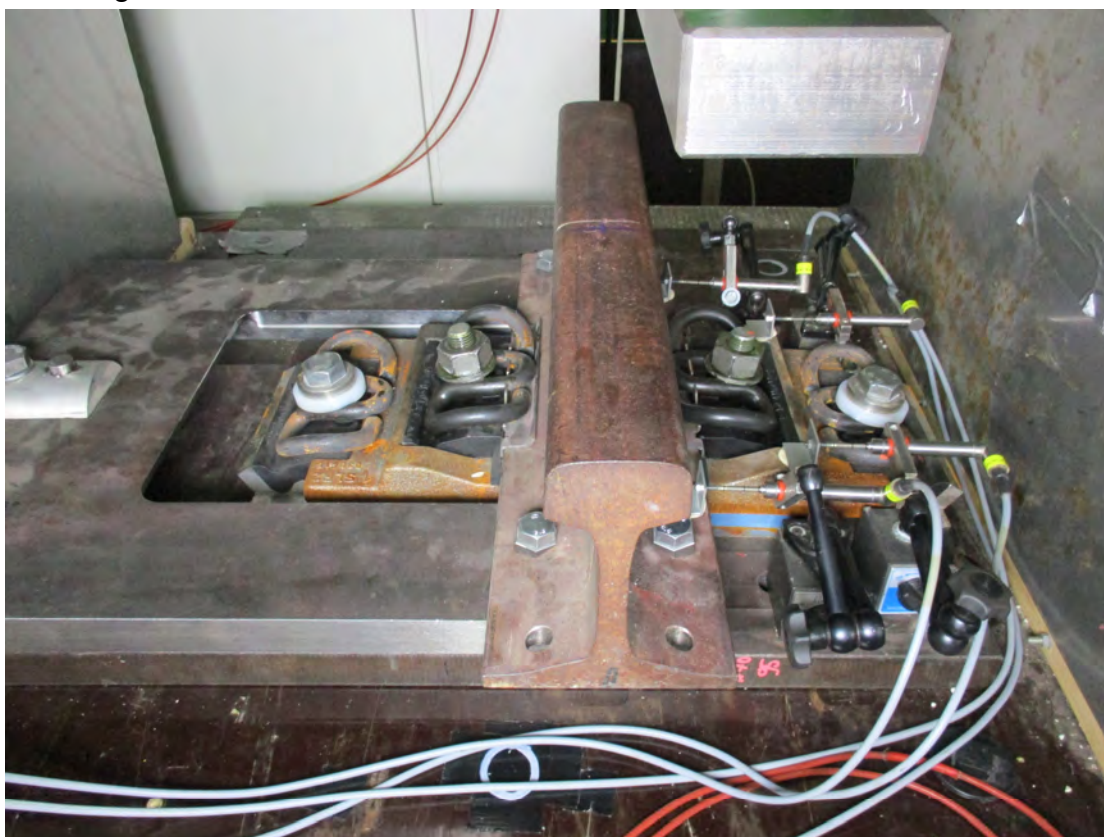
Abbildung 4-5: Prüfaufbau zur Ermittlung der lateralen Steifigkeit des BSP FF-B2 Figure 4-5: Test setup for determination of lateral stiffness of BSP FF-B2
