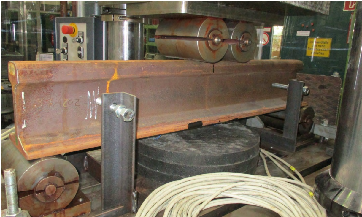
Abbildung 6-30: Prüfaufbaus der 4-Punkt Biegezugprüfung
