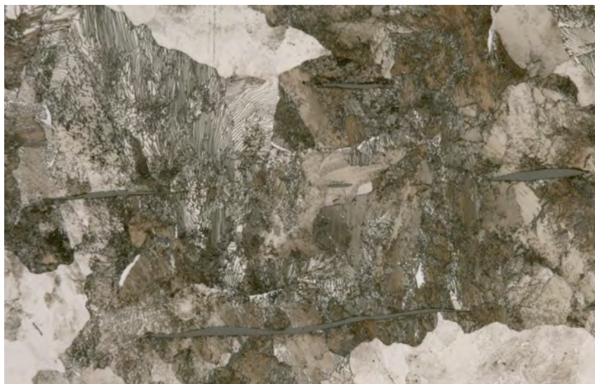
Abbildung 5-1: Längsschliff eines Schienenfußes der Güte R260A in 500facher Vergrößerung
