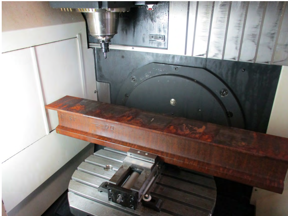
Abbildung 6-28: Schienenprobe in der Fräsmaschine mit Kerbe auf der Schienenfußunterseite
