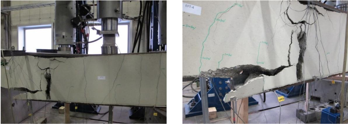
**Abbildung 3-25: (ii.) Riss linker Verankerungsbereich (EFT-4)**
