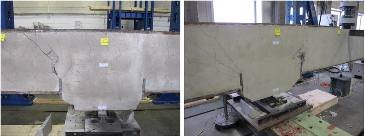
**Abbildung 4-16: (li.) Rissbildung im Beton bei DLT 2 (Rückseite)**
