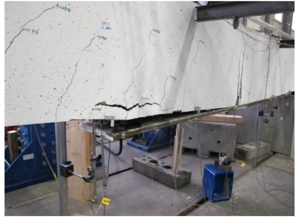
**Abbildung 3-21: (li.) Riss in der Trägermitte (EFT-1)
