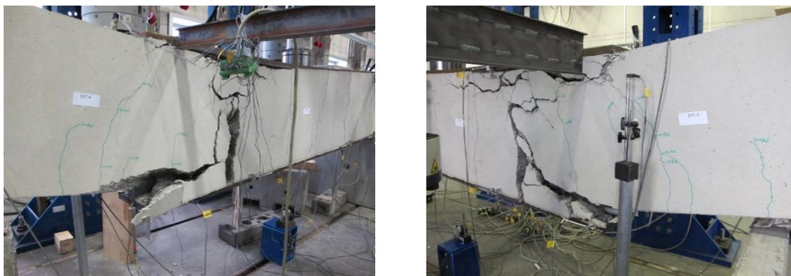
Abbildung B-37: Versagen Pull-Out-Effekt EFT-4 (links: vorne Seit; rechts: hinten Seit)
