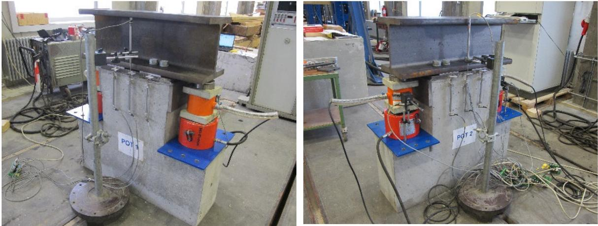
**Abbildung 3-130: (li.) Versuchsaufbau des Pull-Out-Versuchs, Nr. 1
