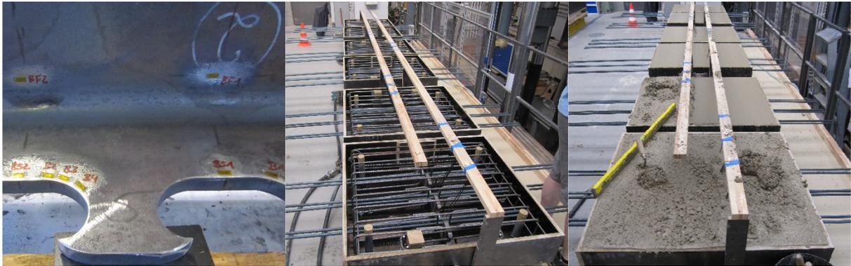
**Abbildung 4-41: Stahlleiste mit Messtechnik (links), Schalung und Bewehrung (Mitte), betonierte Prüfkörper und Materialproben (rechts)**
