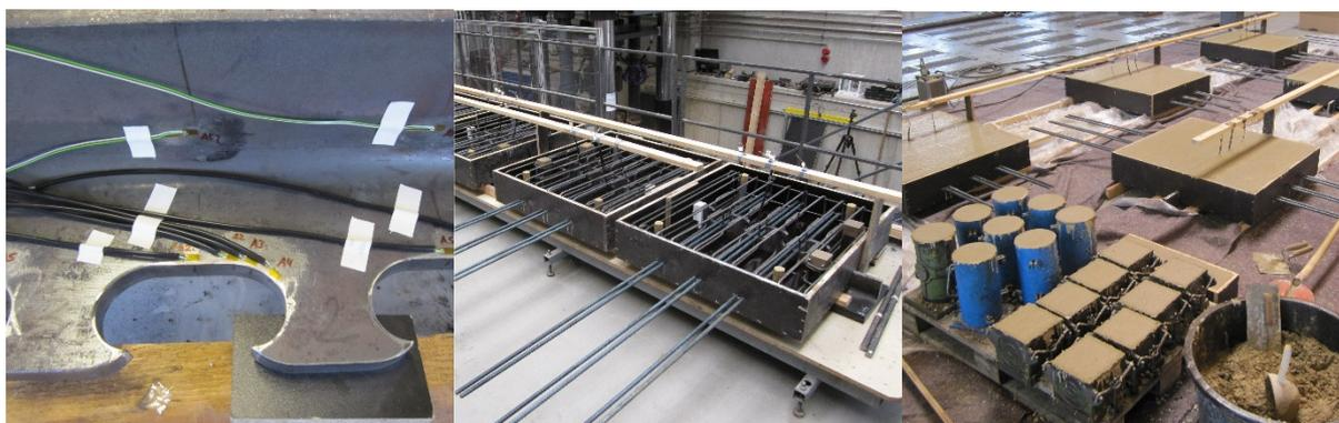
**Abbildung 3-148: Stahlleiste mit Messtechnik (links), Schalung und Bewehrung (Mitte), betonierte Prüfkörper und Materialproben (rechts)**
