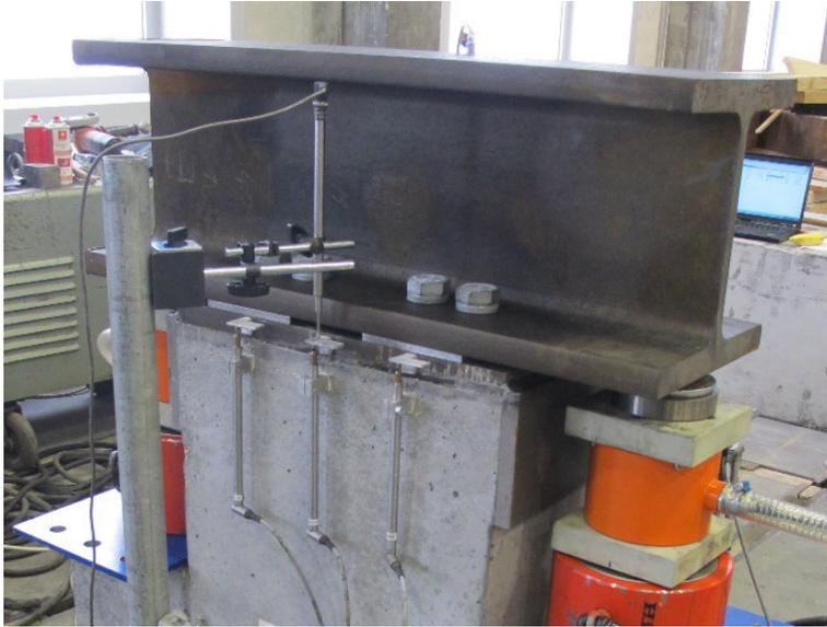
**Abbildung 3-129: Anordnung der Weggeber bei Pull-out-Versuch**
