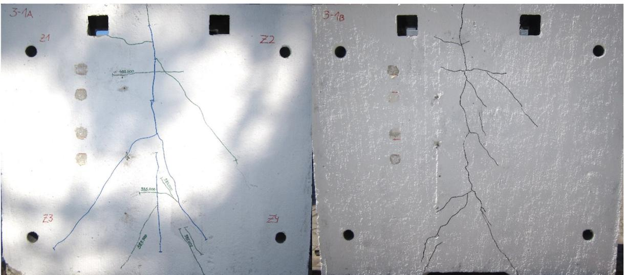
**Abbildung G-4: Betonrissbilder nach Versuch, Platte A (links) und Platte B (rechts)**
