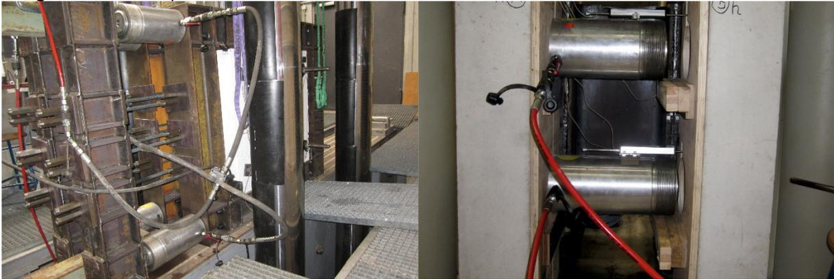
**Abbildung 3-146: Stahlrahmen zur Aufbringung der Querzugbeanspruchung (links), Anordnung der Hydraulikzylinder für die Auszugbeanspruchung (rechts)**
