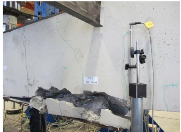
**Abbildung 3-23: (li.) Riss in der Trägermitte (EFT-2)
