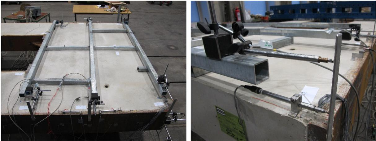
**Abbildung 3-82: Anordnung der Wegaufnehmer zur Messung vertikaler Relativverformungen
