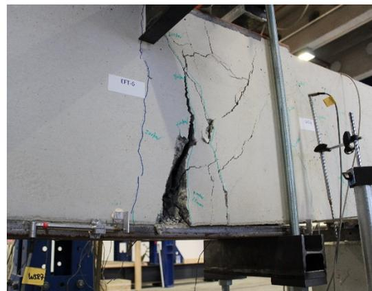
**Abbildung 3-66:** (li.) Riss bei langer Überlängung (EFT2)
