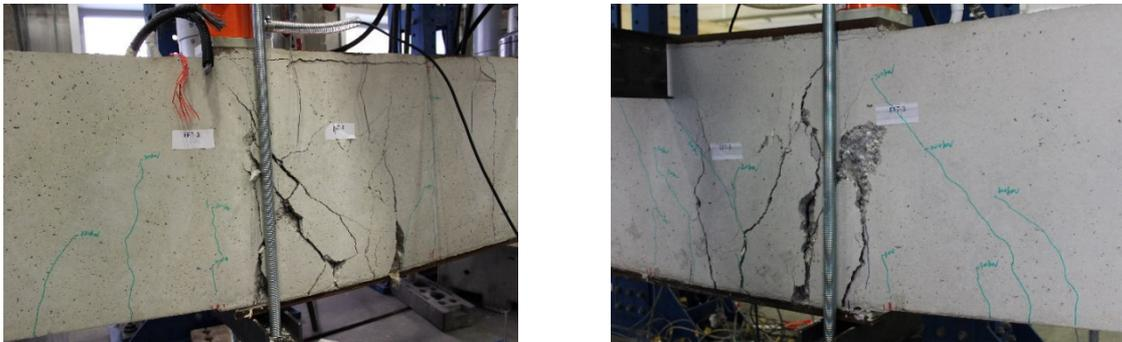
**Abbildung B-28: Versagen Pull-Out-Effekt EFT-3 (links: vorne Seit; rechts: hinten Seit)**
