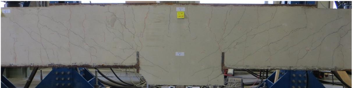
Abbildung 4-10: Risse im Beton von DLT3
