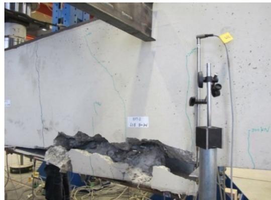
Abbildung B-20: Versagen Pull-Out-Effekt EFT-2 (links: vorne Seit; rechts: hinten Seit)
