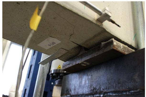
**Abbildung 3-46: (li.) Versagen linker Verankerungsbereich (EFT-6)
