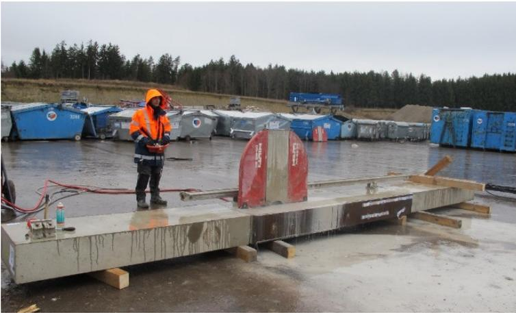
Abbildung 4-38: Aufschneiden der Versuchskörper
