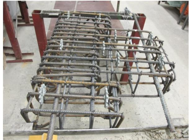
Abbildung 3-125: (li.) Stahldübel für den Pull-Out-Versuch
