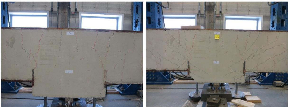
**Abbildung 4-37: Rissbildung am mittleren Lager DLT3**
