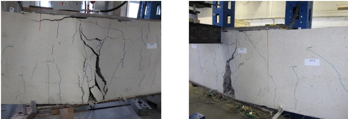
Abbildung B-45: Versagen Pull-Out-Effekt EFT-5 (links: vorne Seit; rechts: hinten Seit)
