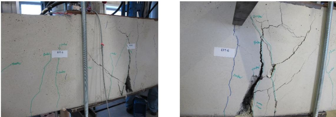
**Abbildung B-54: Versagen Pull-Out-Effekt EFT-3(links: vorne Seit; rechts: hinten Seit)**
