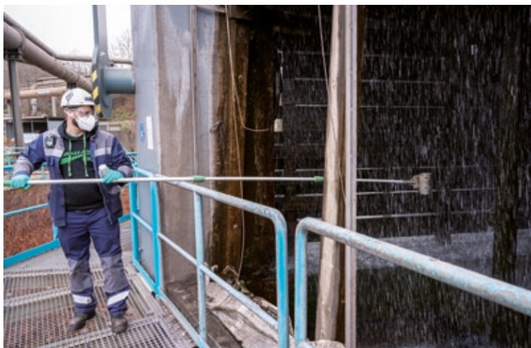
Ein Probennehmer der Chemischen Laboratorien im Außeneinsatz beim Entnehmen einer Kühlwasserprobe.
