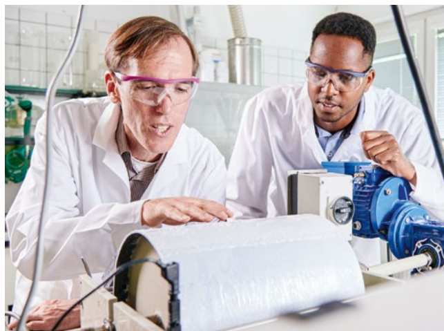
„Responsible Care“-Preisträger Patrik Stenner (l.) hat ein elektrostatisches Verfahren zur Rückgewinnung von Mikropartikeln aus Abwässern entwickelt. Hier mit Yikalo Teclé an der Abscheidewalze.
