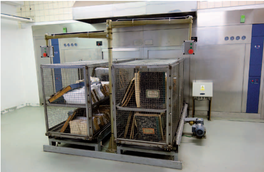
Foto 2: Dekontaminationsanlage für Archiv- und Bibliotheksgut im Nationalarchiv (Foto: Rainer Jedlitschka)
