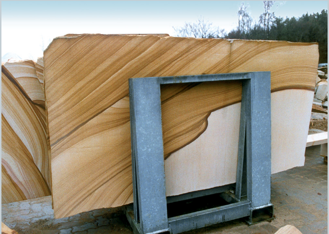
Abb. 4: Ibbenbürener Sandstein mit der typischen Maserung durch Eisenausscheidungen. Parallel zur Schichtung gesägt, ist er ein wertvoller Naturwerk- und Fassadenstein.
