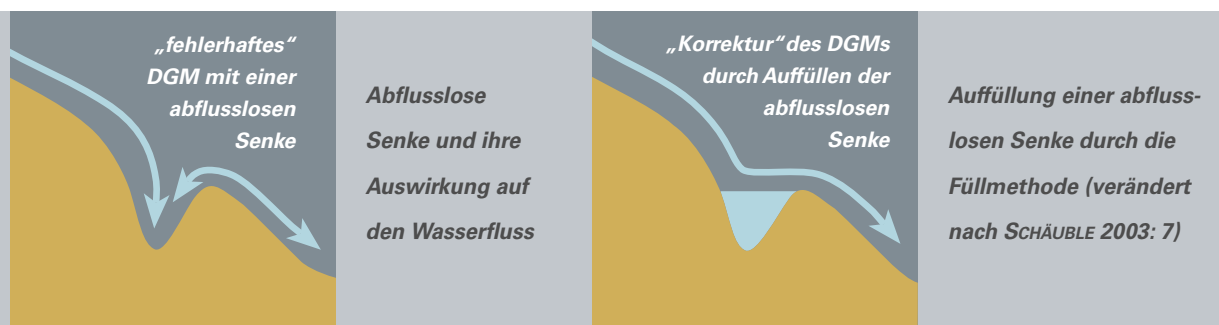
Abb. 16: Detektion abflussloser Senken im DGM mit der Füllmethode
