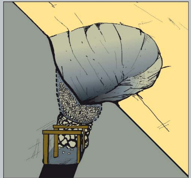
Tagesbruch im Spätstadium (konsolidiert; in Anlehnung an SINGH & DHAR 1997: 334; van den ECKHAUT et al. 2007: 31)
