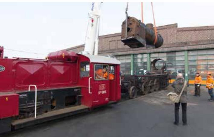
Auf dem Weg zur Reparatur: Der Dampfkessel der Lok Lipperland bekommt eine Runderneuerung, bevor er im Jahr 2019 wieder mit den übrigen Komponenten zusammengefügt werden kann.
