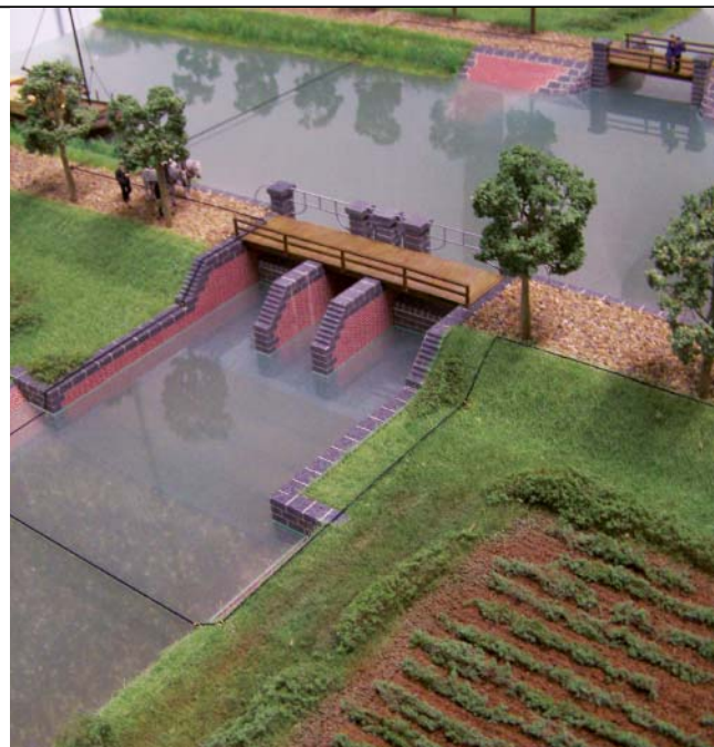
Modell von Prise d'eau (Einlassbau) und dem Épanchoir (Entlastungsbau) als Grundlage für Sanierung und Teilrekonstruktion.
