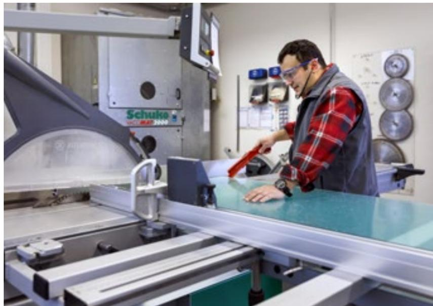
Zuschneiden der Röhre an der Zugsäge
