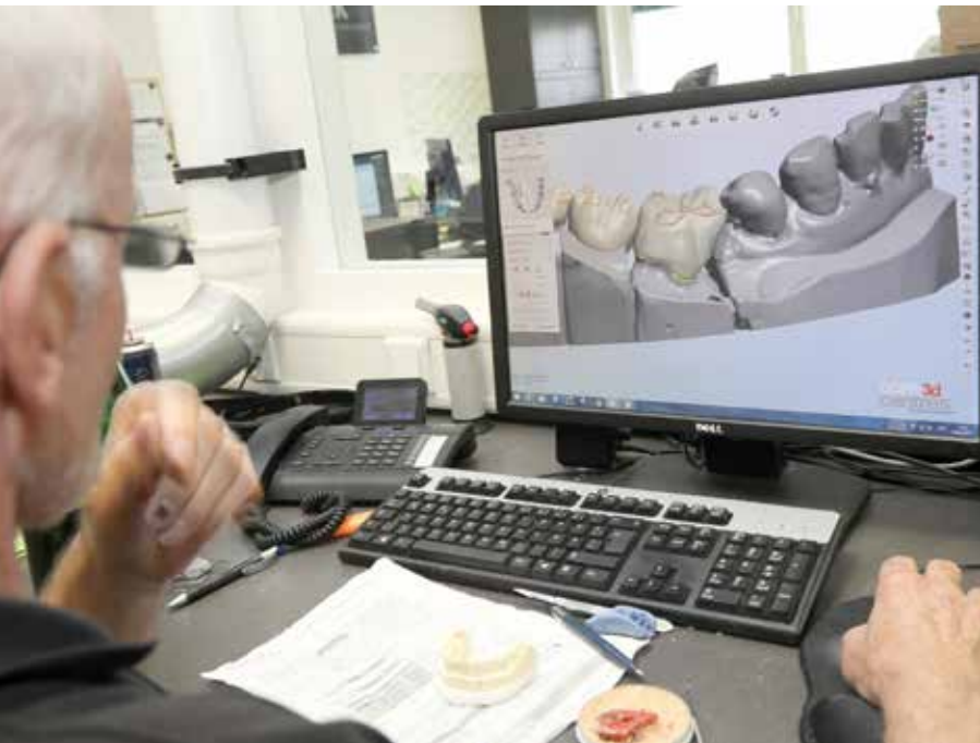
Die digitalen Daten des Mundscanners werden von den Zahntechnikern verarbeitet. Am Computer wird der Zahnersatz virtuell ganz präzise geplant, ehe er dann maschinell gefräst und von Hand finalisiert wird. Rechts: Fräswerkzeuge einer CNC-Maschine. Alle Fotos: Uli Preuß
