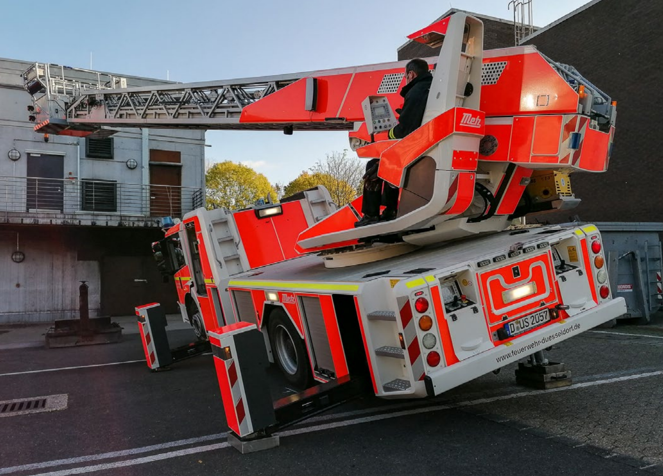
Schiefe Ebene mal anders – auch wenn das Fahrgestell schräg steht, steht der Leiterpark gerade.
