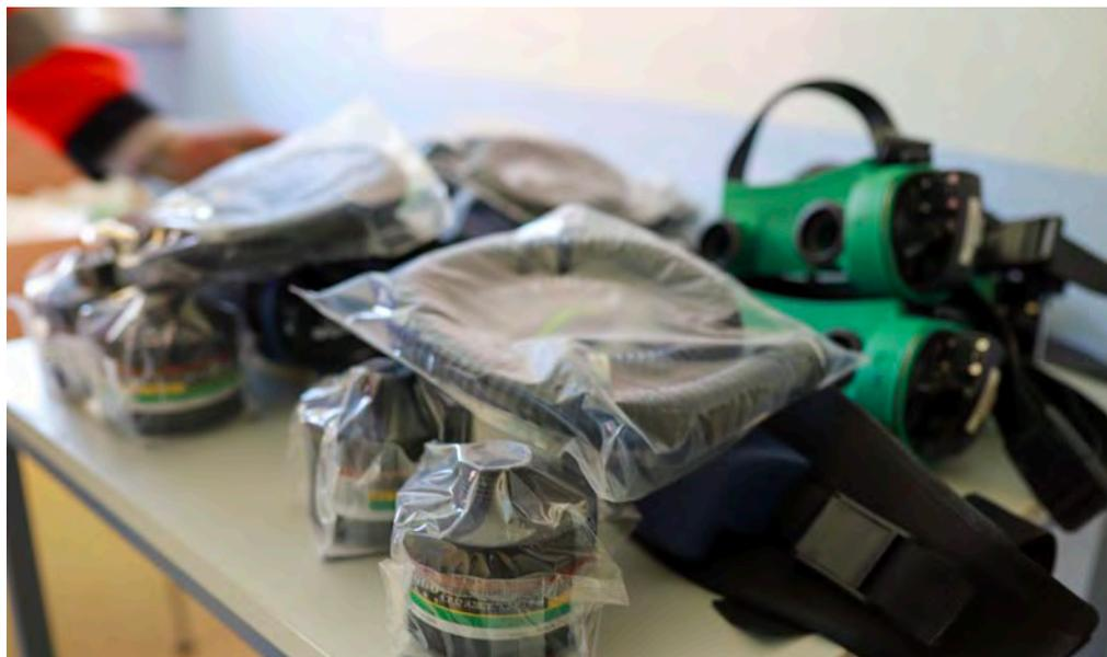
Die Gebläseeinheiten mit Filtern werden vor dem Einsatz vorbereitet
