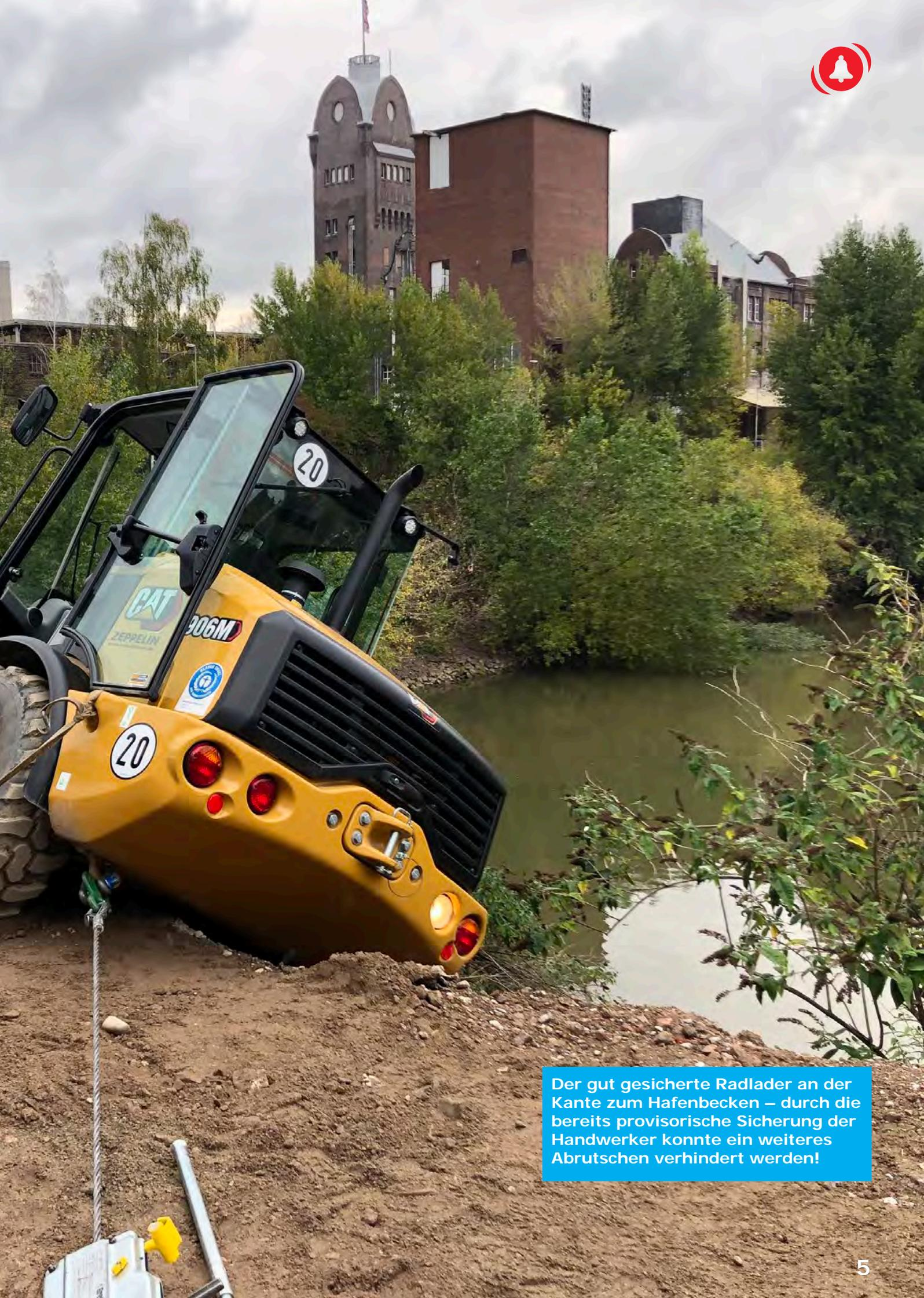
Der gut gesicherte Radlader an der Kante zum Hafenbecken – durch die bereits provisorische Sicherung der Handwerker konnte ein weiteres Abrutschen verhindert werden!
