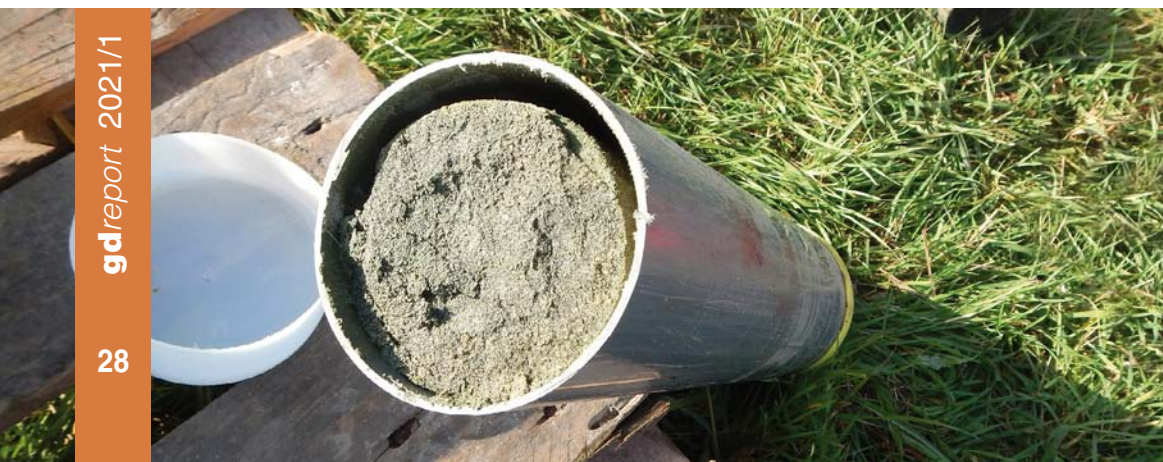
Bohrkern Dorsten-Rhade aus 34 m Tiefe, mit untypisch grünen, glaukonitreichen Sanden der Haltern-Formation
