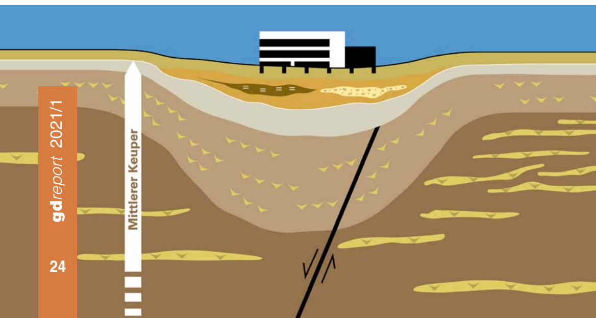
Schnitt durch eine Subrosionssenke (schematisch)
