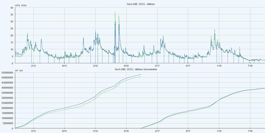
Abbildung 11: Vergleich gemessener mit simulierter Gang- und Summenlinie am Pegel Goch (Niers)
