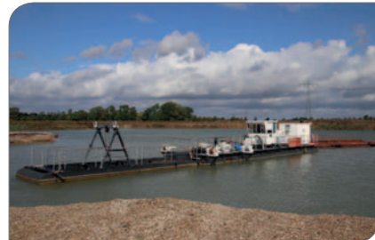
Abb. 1: Kiesgewinnung an der Leine südlich Hannover. Obwohl es natürlich auch viele Trockenkiesgruben gibt, erfordert der meist hohe Grundwasserspiegel häufig eine Kiesgewinnung im Nassabbau, was in der Anlage eines Baggersees resultiert. Foto: BGR.
