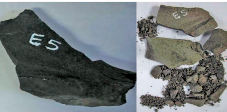
Gesteinszerfall nach nur drei Jahren. Durch Kenntnis der magnetischen Suszeptibilität könnte ein Abschlag schon beim Sprengbohrlochbohren auf eine solche Anomalie abgeklopft werden. Quelle: TU Clausthal
