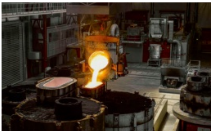
In der Gießerei in Georgsheil im Landkreis Aurich recycelt Enercon Stahlschrott aus der Generator-Produktion. Um das zu ermöglichen, hat thyssenkrupp Steel die Materialzusammensetzung des Stahls optimiert.
