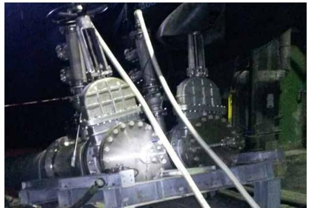
**Bild 9.4** – Explosionsfester Verschluss
