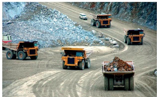
**Bild 6.2** – Transport des gewonnenen Materials mittels SKW (Quelle: Rheinkalk GmbH)
