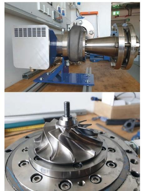
Abb. 2: Turbine und Turbinenlaufrad
