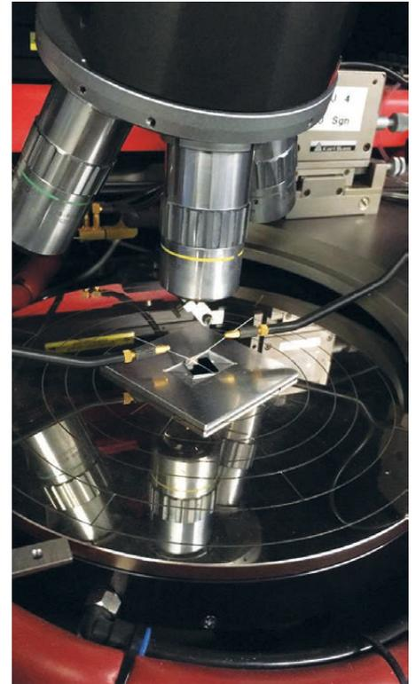
Abb 2: Kontaktierung der Mikrostrukturen auf kleinen Waferstücken in einem halbautomatischen Prober. Quelle: Forschungszentrum Jülich.
