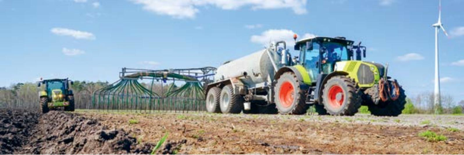
Durch bodennahe Ausbringung der Gülle mit Schleppschräuchen und direktes Einarbeiten in den Boden entweicht weniger Ammoniak in die Luft
