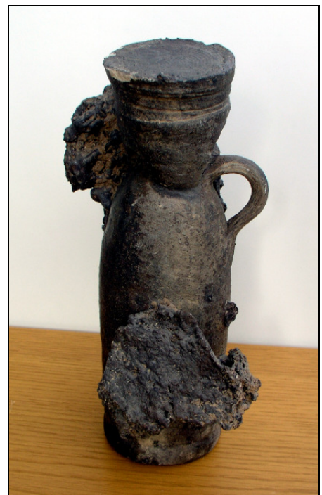
Nicht jeder Brand gelang, stark verschlufte Fehlbrandstücke, rechts: Flasche mit aufgesetzter Brennhilfe
