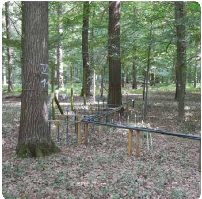
Messung der Bodenwasserspannung mit Tensiometern auf der Level-II-Fläche Kleve Tannenbusch
