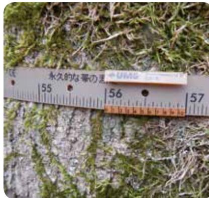
Dendrometer zum Messen des Durchmessers einer Buche auf der Level-II-Fläche Haard
