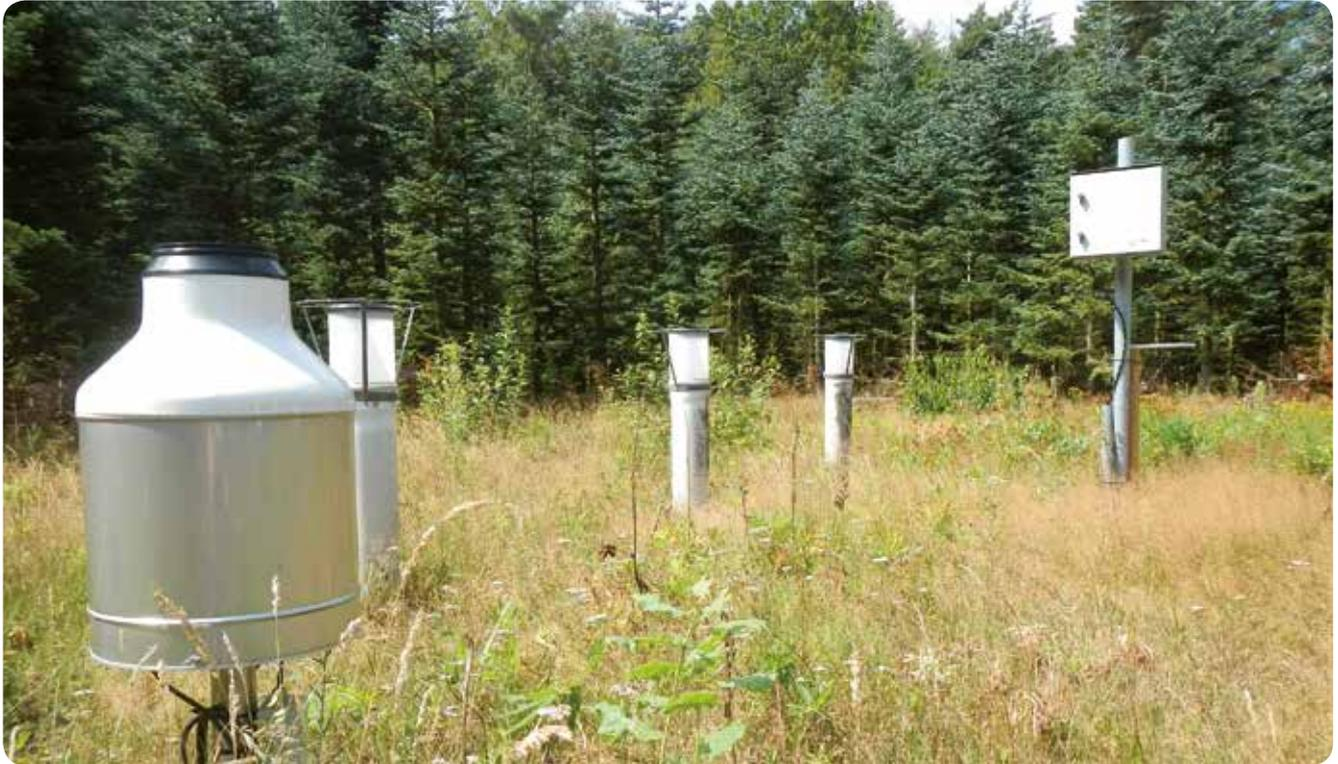
Depositions- und Niederschlagsmessung auf der Level-II-Freifläche Kleve
