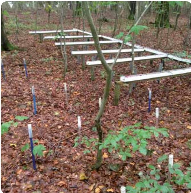
Messung der Bodenwasserspannung mit Tensiometern auf der Level-II-Fläche Schwaney
