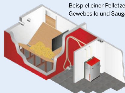
Beispiel einer Pelletzentralheizung mit automatischer Schneckenförderung aus dem benachbarten Lagerraum
