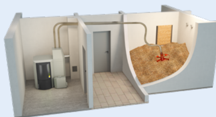
Pelletlagerraum, die Saugaustragung erfolgt über einen Maulwurf
