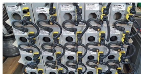
Die BOB-Akkus im Versuchsaufbau: Li-Ion Batterien ersetzen den Diesel-Range-Extender und werden auf ein „zweites Leben“ in alternativen Anwendungen getestet.
