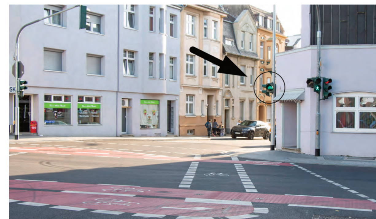
Die Radfahrer, die an der Aufstellfläche warten, haben ein eigenes Signal, wenn sie losfahren können. Die Radfahrer-Ampel schaltet sich einige Sekunden eher auf Grün als die Signalanlage für Autofahrer, die hinter der Aufstellfläche auf die Weiterfahrt warten.
