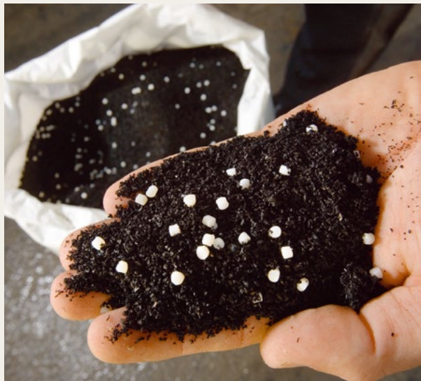
VESTENAMER® (weißes Granulat) von Evonik ermöglicht die effiziente Wiederverwertung von Gummi (schwarzes Granulat).
