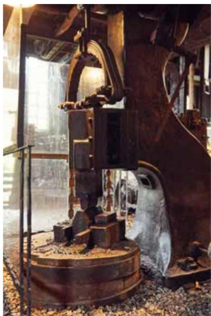
Im noch funktionierenden Steffenshammer kann man erleben, wie mit der Kraft des Wassers über ein Wasserrad der Hammer in Gang gesetzt und Werkzeug geschmiedet wird.
