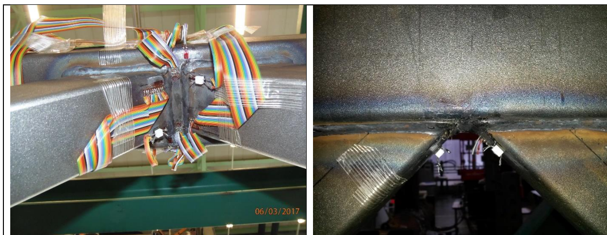
Abbildung 3-14: Drauf- und Seitenansicht Probekörper K45-RHS-130x4-80x4-S700-2
