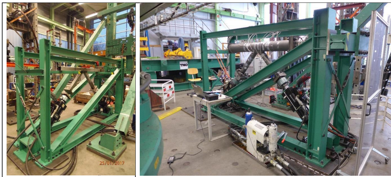
Abbildung 3-7: Versuchsrahmen bei TNO für kleine K-Knoten
