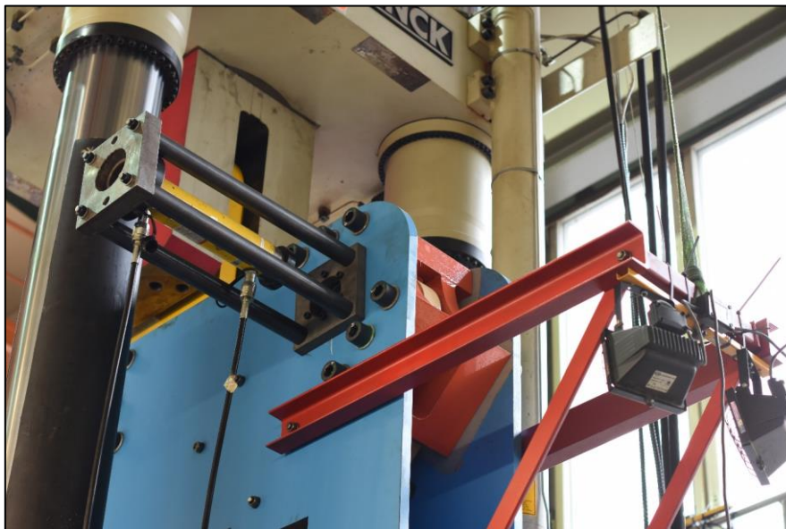
Abbildung B1-12: Ausgeführter Bolzenschieber
