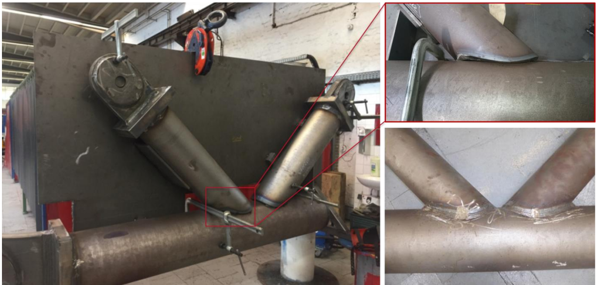
Abbildung 3-5: Herstellung der großen K-Knoten (Konecranes GmbH)
