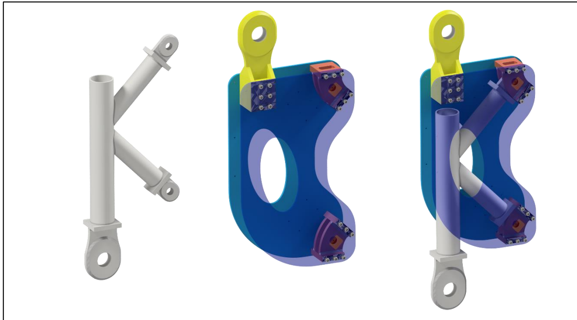
Abbildung B1-8: gewichtsoptimiertes, nahezu finales Konzept
