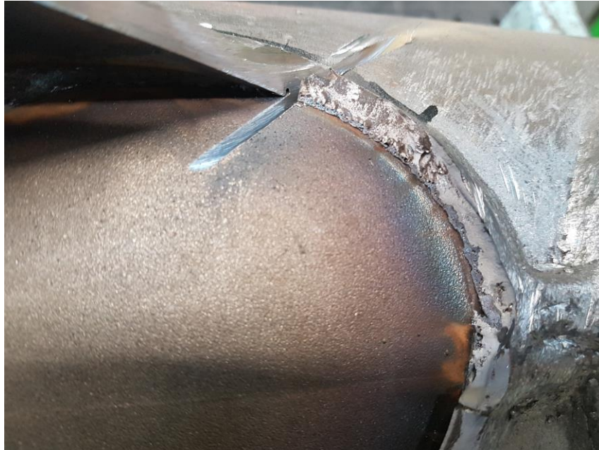
Abbildung 3-11: Bruchfläche Probekörper K45-193.7x10-114.3x6.3-g25-S700-8
