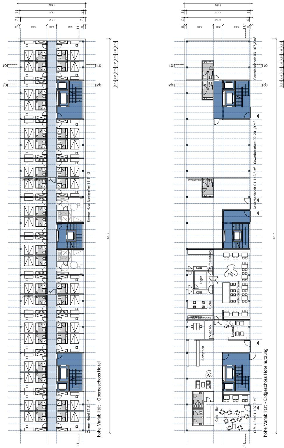
Abbildung B-26: Grundrisse Regelgeschoss und Erdgeschoss Referenzgebäude mit hoher Variabilität für eine Hotelnutzung
