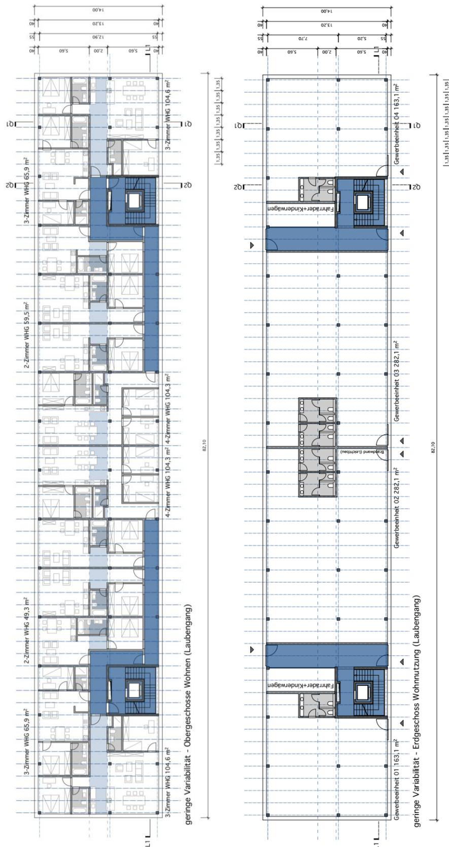
Abbildung B-6: Grundrisse Regelgeschoss und Erdgeschoss Referenzgebäude mit geringer Variabilität für eine Wohnnutzung
