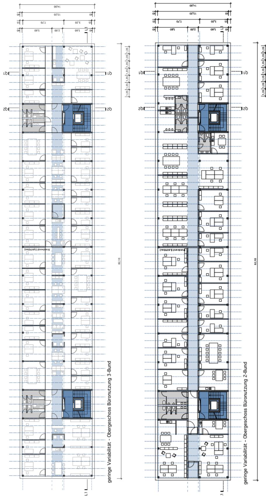
Abbildung B-3: Grundrisse Regelgeschosse Referenzgebäude mit geringer Variabilität für eine Büronutzung
