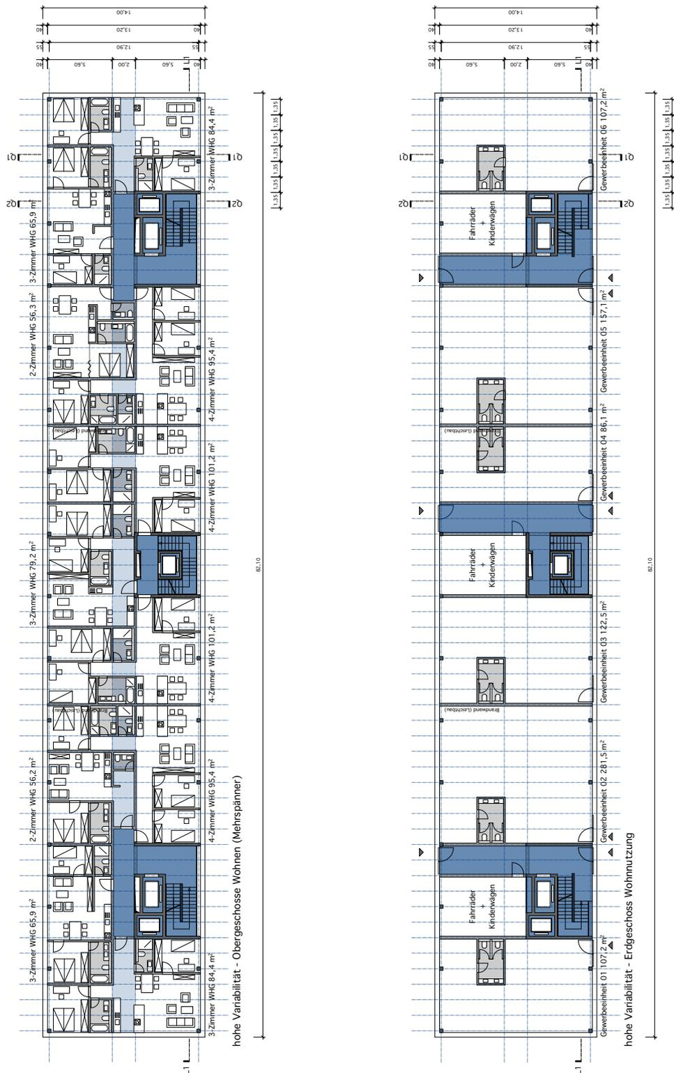
Abbildung B-24: Grundrisse Regelgeschoss und Erdgeschoss Referenzgebäude mit hoher Variabilität für eine Wohnnutzung
