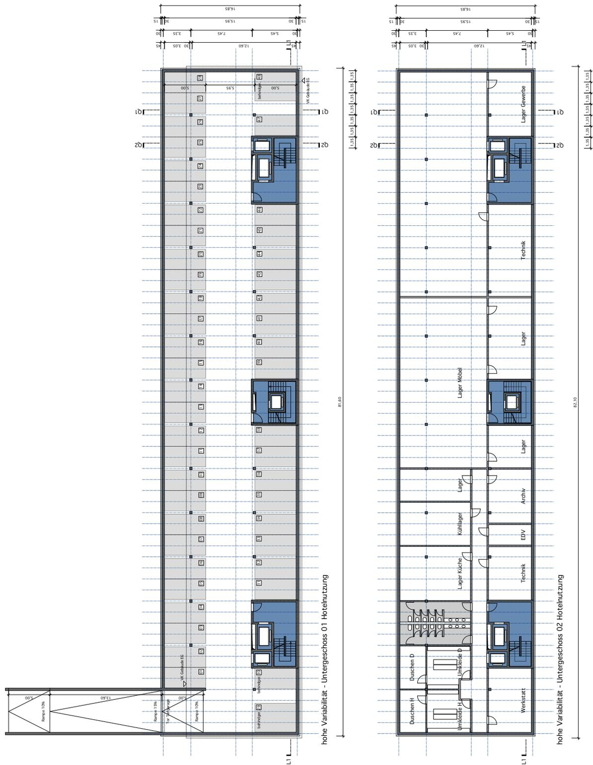
Abbildung B-27: Grundrisse Untergeschosse Referenzgebäude mit hoher Variabilität für eine Hotelnutzung
