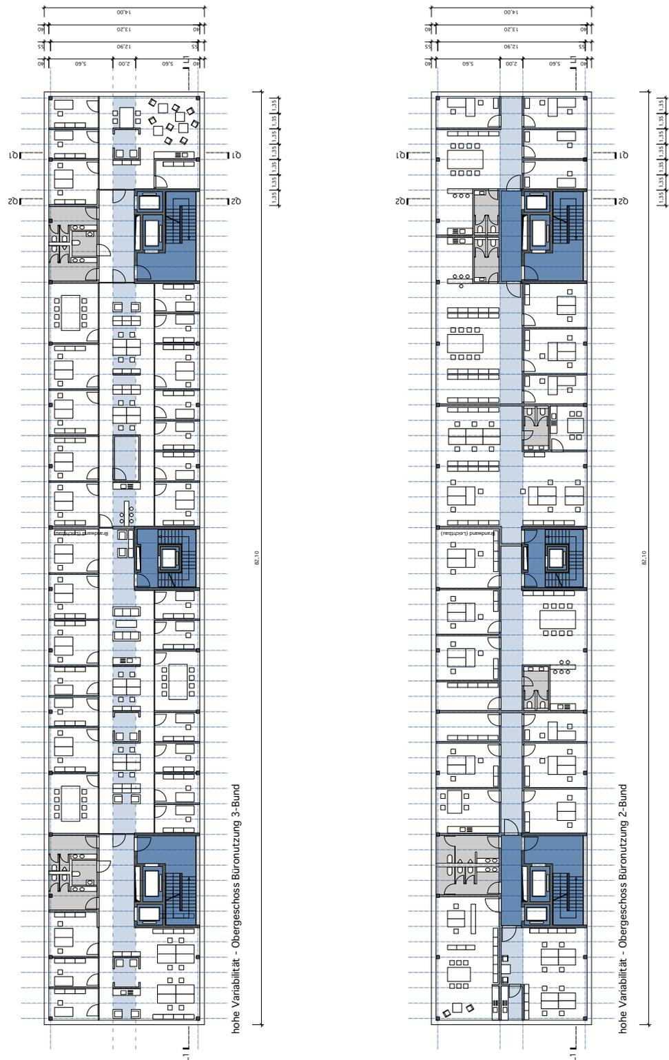
Abbildung B-21: Grundrisse Regelgeschosse Referenzgebäude mit hoher Variabilität für eine Büronutzung
