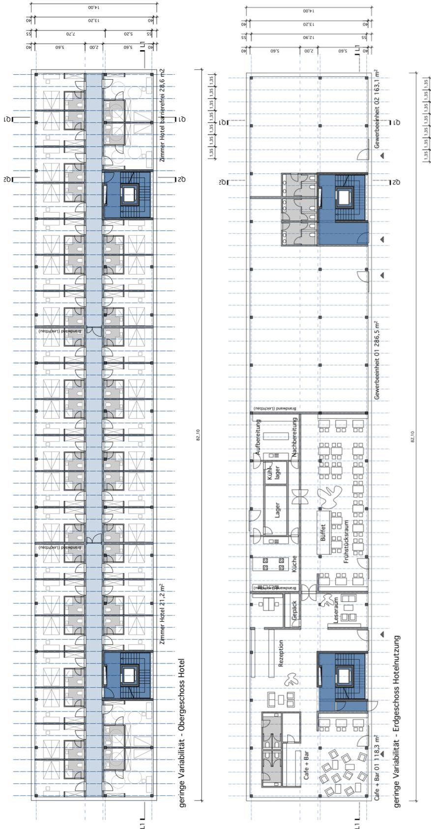
Abbildung B-8: Grundrisse Regelgeschoss und Erdgeschoss Referenzgebäude mit geringer Variabilität für eine Hotelnutzung
