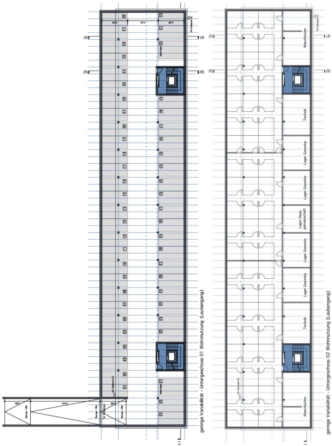
Abbildung B-7: Grundrisse Untergeschosse Referenzgebäude mit geringer Variabilität für eine Wohnnutzung
