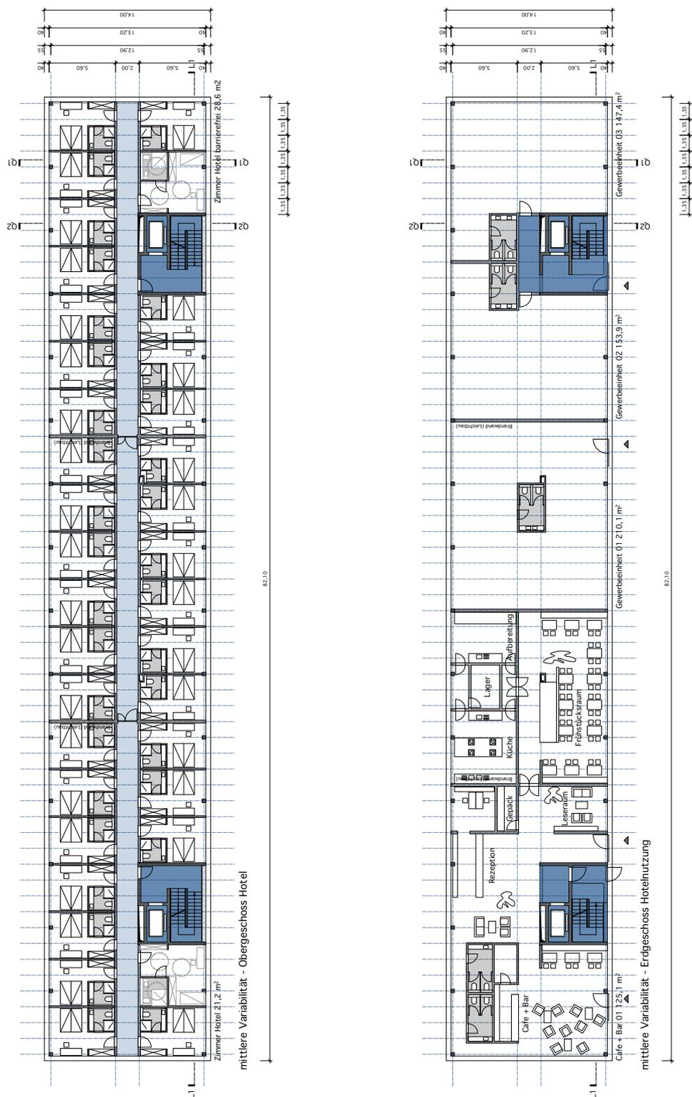
Abbildung B-17: Grundrisse Regelgeschoss und Erdgeschoss Referenzgebäude mit mittlerer Variabilität für eine Hotelnutzung
