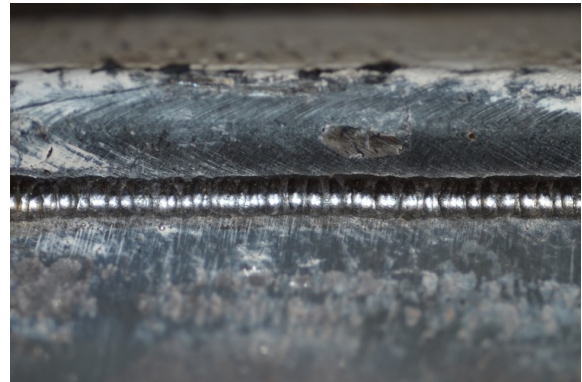
Abbildung 2.4: PIT Spur am Schweißnahtübergang
