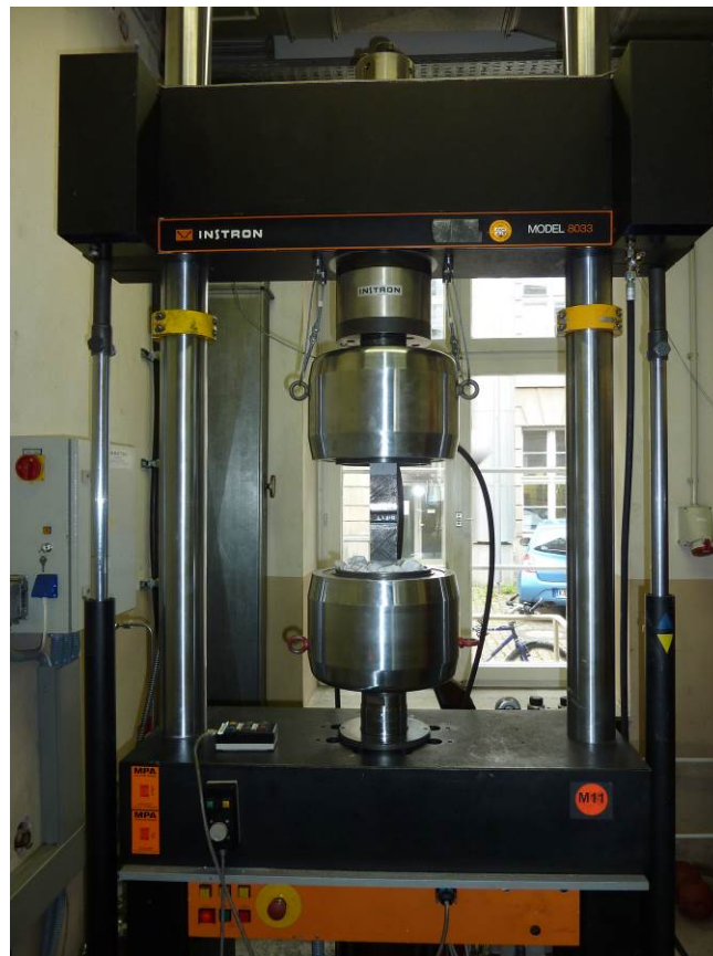
Abbildung 4.1: Ermüdungsversuch an HFH-behandelter Quersteife am KIT
