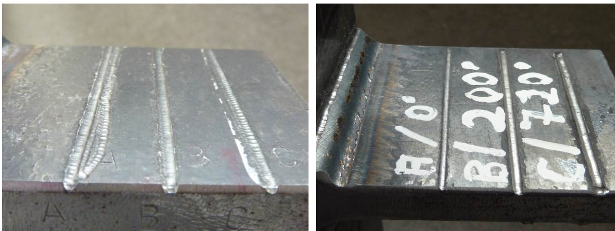
Abbildung 3.7: HFH-Behandlung am Grundmaterial der Steifen, PIT (links) und HiFIT (rechts), Intensitäten: niedrig (A), optimal (B) und hoch (rechts)
