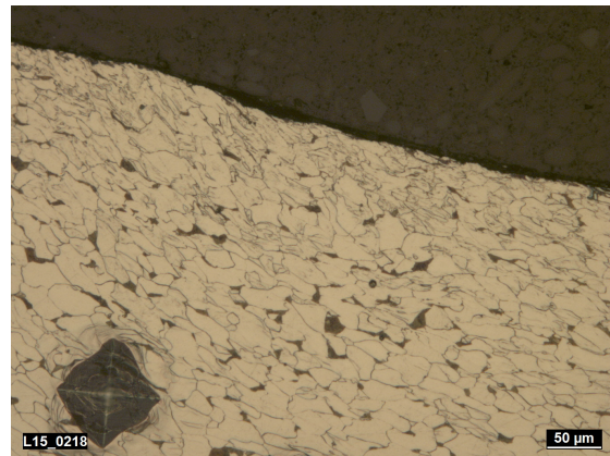
Abbildung 3.34: Durch HFH verändertes Gefüge im randnahen Bereich Figure 3.34: HFMI affected microstructure close to the surface
