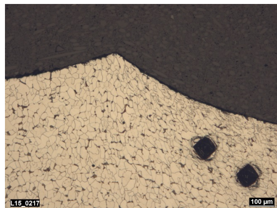
Abbildung 3.32: Härtemessungen in Querrichtung
