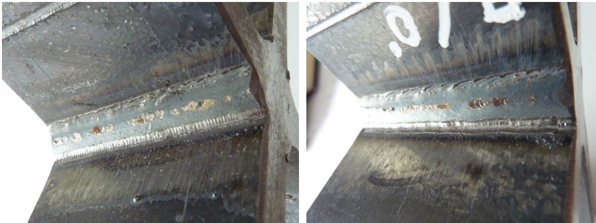
Abbildung 3.6: HFH-Behandlung am Nahtübergang der Quersteifen, PIT (links) und HiFIT (rechts)
