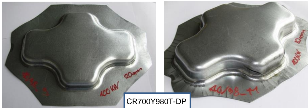
Abbildung 6-3: CR700Y980T-DP; (links) Geometrie 1, Ziehtiefe: 20 mm, NHK: 100 kN kein Riss (rechts) Geometrie 1, Ziehtiefe: 30 mm NHK: 100 kN Falten + Riss
