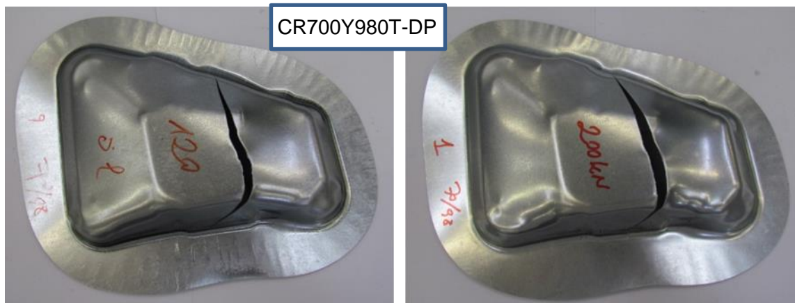
Abbildung 6-7: CR700Y980T-DP, BSU-Bauteil, links) Niederhalter Kraft: 120 kN, Ziehtiefe: 44 mm, Öl, Falten + Riss, rechts) Niederhalter Kraft: 200 kN, drawing depth: 44 mm, Ziehfolie, Falten + Riss
