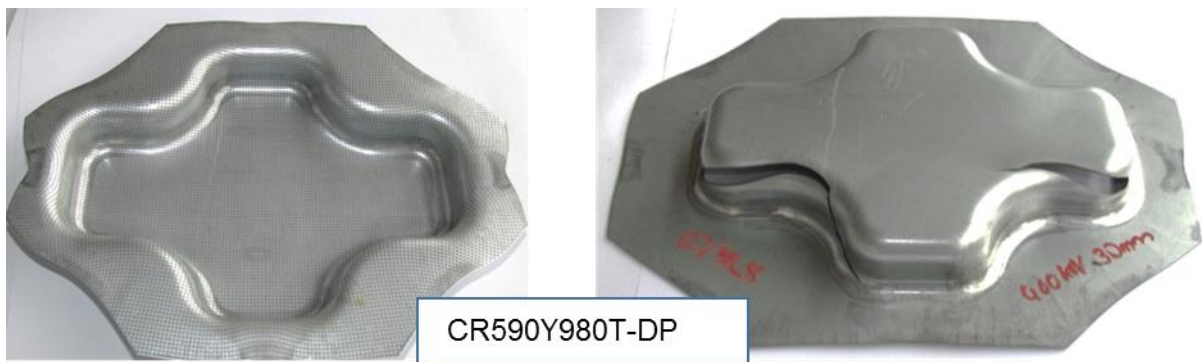
Abbildung 6-2: CR590Y980T-DP links) Geometrie 1, Ziehtiefe: 38 mm, NHK: 400 kN ohne Riss; rechts) Geometrie 2, Ziehtiefe: 30 mm, NHK: 400 kN mit Rissen
