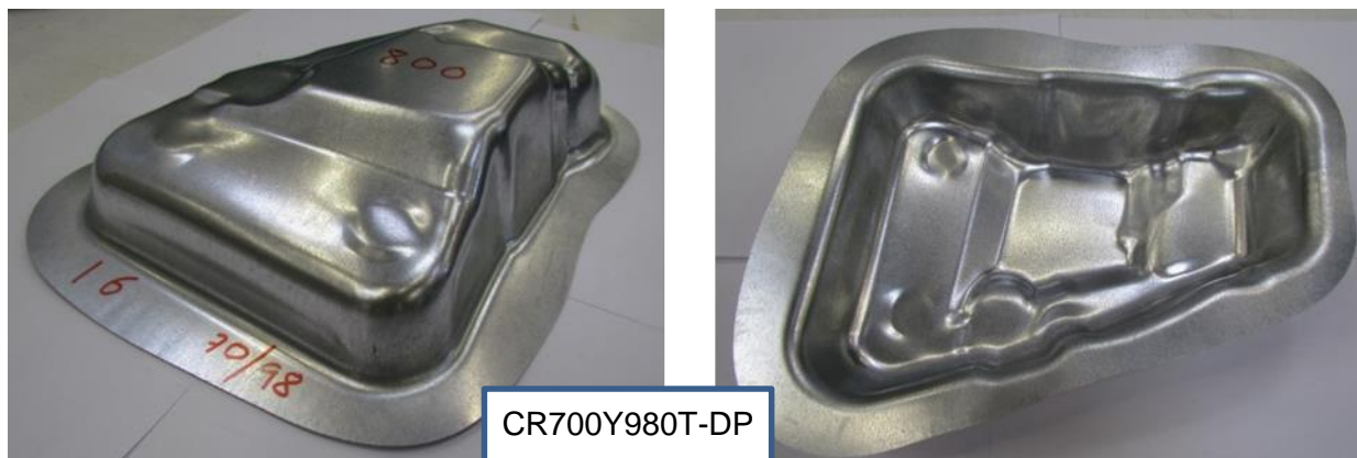
Abbildung 6-9: CR700Y980T-DP, BSU-Bauteil, Niederhalter Kraft: 800 kN, Ziehtiefe: 65 mm, Ziehfolie + Öl, kein Riss
