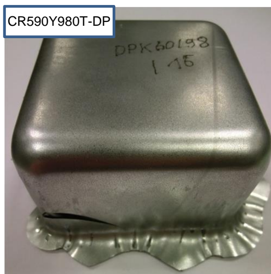
Abbildung 6-5: CR590Y980T-DP, Vierkantnapf, Riss bei 42,2mm Tiefziehtiefe
