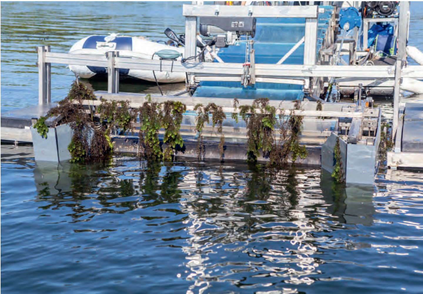
Der Rollenpflücker, dessen Wirksamkeit im Forschungsvorhaben „Elodea II“ erprobt werden soll, ist eine patentierte Neuentwicklung.
