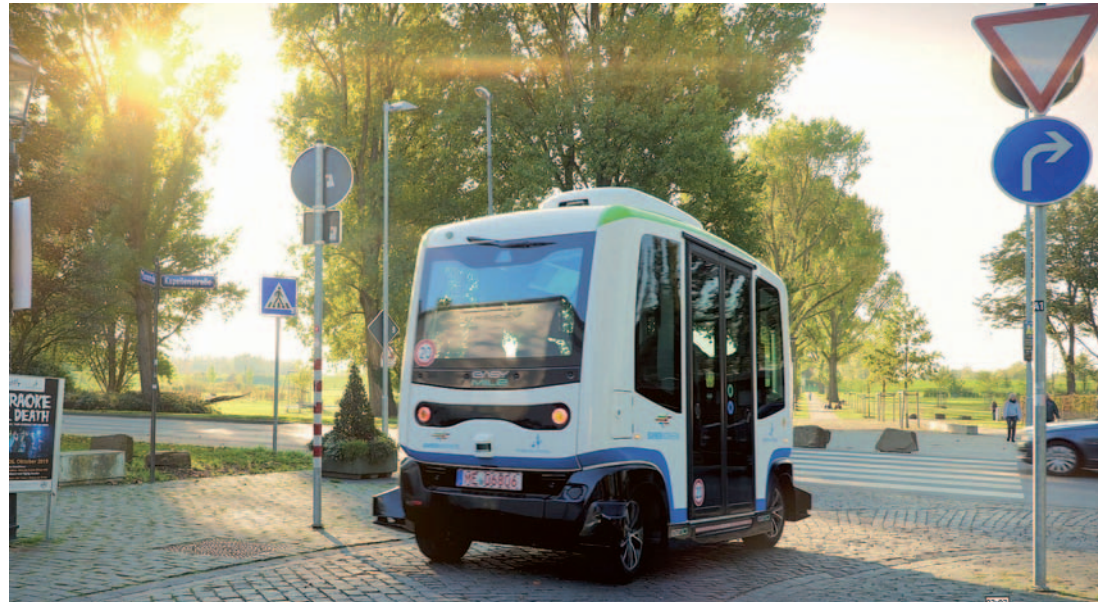
Die autonom fahrenden Busse folgen einer vordefinierten Route und sind mit einer Vielzahl von Sensoren ausgestattet. Foto: Screenshot
