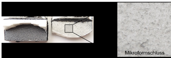
Bild 68: Bruchbild einer mittels Lasersintern hergestellten Zugscherprobe
