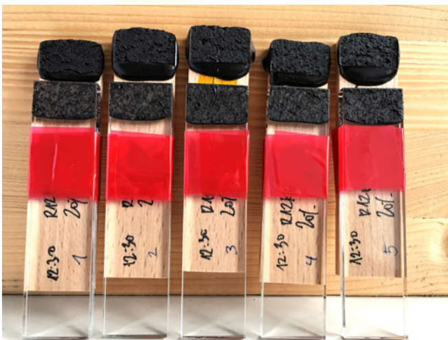
Bild 44c: Bruchbilder von Holz/Glas-Klebung
