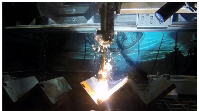
Bild 82: Unterwasserschweißen in der Innenüberdruckkammer des IW Hannover
