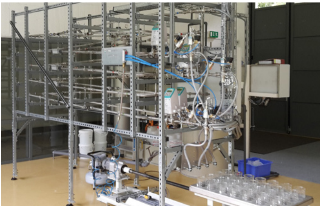
Bild 64: Trinkwasserprüfstand nach DIN EN 15664 mit automatischem Probennehmer.
