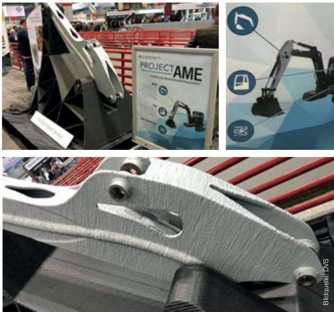
Bild 31: Gelenkausleger eines Baggers, gefertigt mittels WAAM-Verfahren (Prototyp, ausgestellt auf der FABECH, 6. – 9. November 2017, Chicago, USA)
