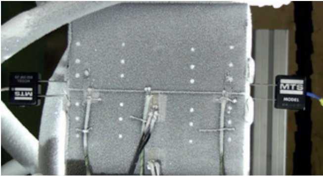
Bild 61: Ausschnitt einer Grobzugprobe aus S355NL mit der Schweißnaht in der Mitte (horizontal) und diversen Sensoren, Prüfung bei -35^{\circ}\text{C}
