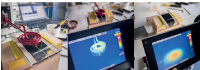
Bild 39: Induktive Schnellhärtung einer Holz-Glas-Klebung mit Curie-Partikeln
