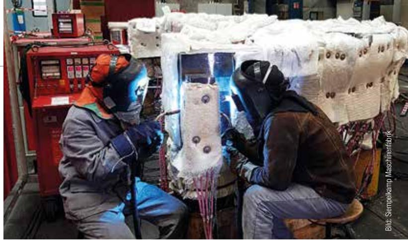
Vorwärmung und Schweißarbeiten der Flanschverbindung an einer Tragringhälfte
