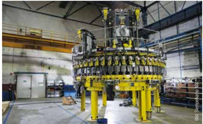
Fertig montierte Schraubenspannmaschine
