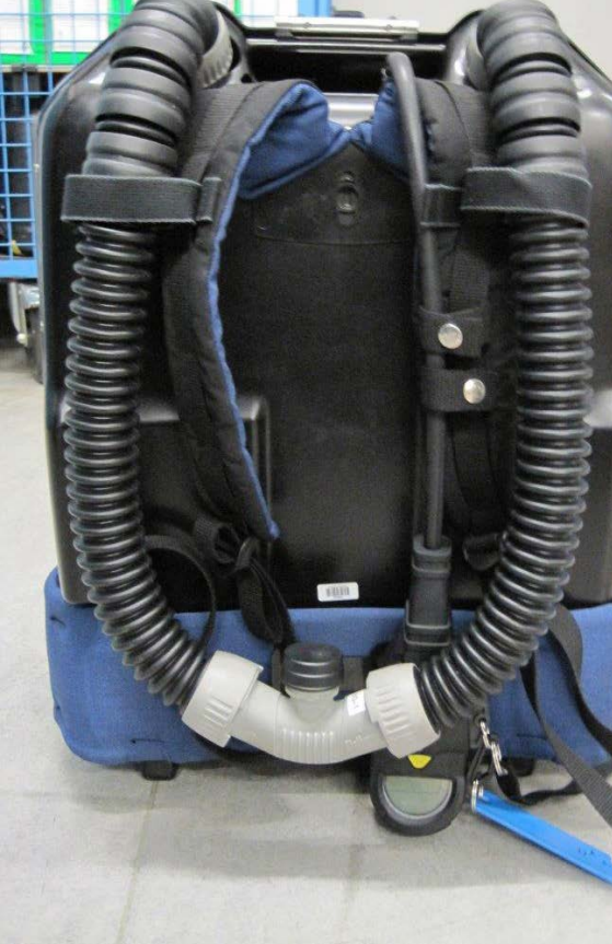
Rückseite des BG 4 mit dem Anschluss für den Atemanschluss
