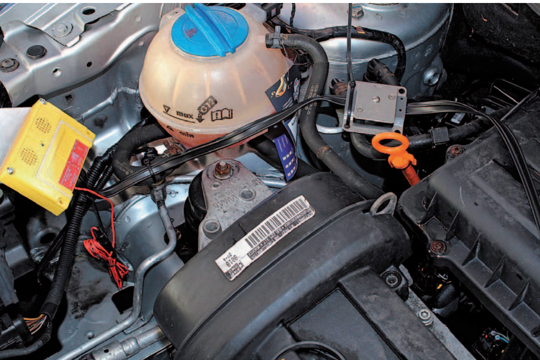
Marderabwehrgerät (siehe gelbes Gehäuse) im Motorraum.
