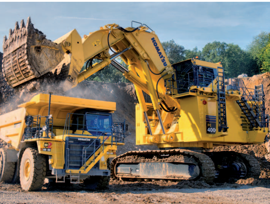
Nach zwei Schaufeln aus dem PC 4000 ist der Muldenkipper der Kalkwerke Oetelshofen erfolgreich voll beladen. Fotos (4): Mikko Schümmelfeder
