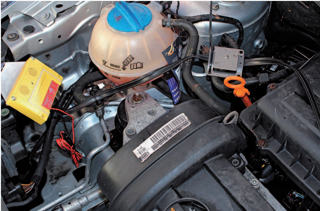
Marderabwehrgerät (siehe gelbes Gehäuse) im Motorraum.
