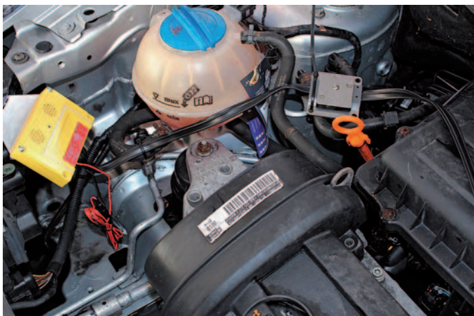
Marderabwehrgerät (siehe gelbes Gehäuse) im Motorraum. Foto: GTÜ Gesellschaft für Technische Überwachung GmbH
